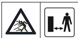
**AVERTISSEMENT** : maintenez une distance de sécurité entre la machine en fonctionnement et vous. Maintenez les mains et les pieds à distance des lames en rotation.
