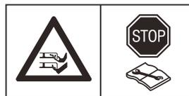
**AVERTISSEMENT** : Actionnez le dispositif de désactivation avant de travailler sur la machine ou la soulever.
