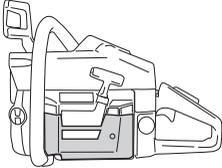
**ACHTUNG!** Ist ein spezieller Wintersatz montiert oder wurden temperatursteigernde Maßnahmen vorgenommen, so müssen diese Modifikationen vor der Anwendung bei normalen Temperaturen wieder rückgängig gemacht werden. Ansonsten besteht die Gefahr, dass das Gerät überhitzt wird, was schwere Motorschäden verursachen kann.
