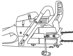
Die Kette ist richtig gespannt, wenn sie an der Schienenunterseite nicht durchhängt und noch leicht von Hand durchgezogen werden kann. Die Schienenspitze anheben und dabei gleichzeitig die Schienenmuttern mit dem Kombischlüssel festschrauben.
