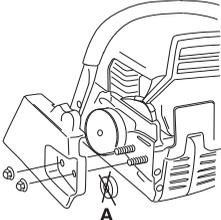
Nataknite meč na vijaka, tako da je v skrajnem zadnjem položaju. Nadenite verigo na pogonski zobnik in v žleb meča. Začnite na zgornjem robu meča.
