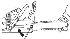
An einer neuen Kette muss die Kettenspannung oft kontrolliert werden, bis die Kette eingefahren ist. Die Kettenspannung regelmäßig prüfen. Mit einer richtig gespannten Kette wird eine gute Schnittleistung und eine lange Lebensdauer erzielt.
