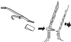
Wir empfehlen eine Führungsschiene Länge zu benutzen, die größer ist als der Stammdurchmesser, sodass Kerb- und Fällschnitt mit einem sog. einfachen Sägeschnitt ausgeführt werden können. Siehe die Anweisungen unter der Überschrift Technische Daten
