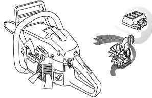
**WICHTIG!** Um die Funktion der Zentrifugalreinigung aufrecht zu erhalten, muss diese regelmäßig gewartet und gepflegt werden. Den Lufterinlass der Startvorrichtung, die Gebläseflügel des Schwungrads, den Raum um das Schwungrad, das Ansaugrohr und den Vergaserraum reinigen.
