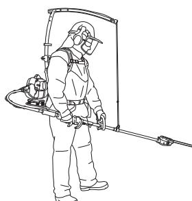
8 Przechodząc na inne miejsce pracy należy wyłączyć silnik. Podczas przemieszczania się na dłuższych odcinkach bądź w czasie transportu, należy używać osłony transportowej.
