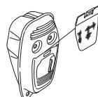
U tlumiče zvuku bez katalyzátoru je zapotřebí sítku čistit a eventuálně vyměnit jednou týdně. U tlumiče zvuku s katalyzátorem je zapotřebí sítku kontrolovat a eventuálně čistit jednou měsíčně. **Poškozenou sítku je nutno vyměnit.**
