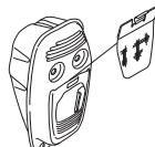
W tłumikach bez katalizatora siatka przeciwiskrowa powinna być czyszczona lub wymieniana raz w tygodniu. W tłumikach z katalizatorem należy sprawdzać i ewentualnie czyszczyć siatkę raz w miesiącu. **Uszkodzoną siatkę należy wymienić.**
