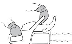
Dodajte puni gas i aktivirajte kočnicu za lanac tako da nagnete zglop na ruci prema naprijed prema prednjem štitu za ruku. Nemojte ispuštiti prednju ruku. **Lanac bi se trebao odmah zaustaviti.**
