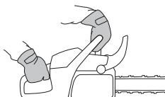
Wciśnij dźwignię gazu do oporu i włącz hamulec łańcucha obracając nadgarstek lewej ręki w kierunku zabezpieczenia przed odbiciem. Nie zdejmuj dłoni z uchwytu przedniego.
