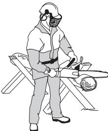
4 **Reťazová píla sa nesmie používať nad úrovňou ramien. Vyhýbajte sa rezaniu špičkou vodiacej lišty. Nikdy nepracujte len jednou rukou!**
