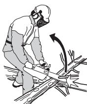
Morate imati nadzor nad predmetom rada. Kada su dijelovi koje namjeravate rezati mali i lagani, mogu se zaglaviti u i biti izbačeni prema vama. Čak i kada niste u opasnosti, možete se iznenaditi i izgubiti nadzor nad pilom. Uvijek razdvojite poredane trupce ili grane prije rezanja. Pilite isključivo pojedinačne trupce ili komade drva. Uklonite isplijene dijelove kako biste održali sigurnost radnog područja.
