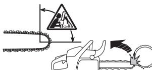
Odbicie powstaje zawsze w płaszczyźnie łańcuchowej prowadnicy. Zazwyczaj pilarka i prowadnica zostają odrzucone do tyłu i do góry, w kierunku operatora. Pilarka może zostać odrzucona w kierunku zależnym od swego położenia w momencie, gdy strefa odbicia natrafia na twardy przedmiot.
