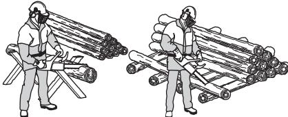
**Kmen leží na zemi.** Nehrozí příliš velké nebezpečí sevření řetězu a zlomení kmene. Hrozí však nebezpečí, že se řetěz dotkne země při dokončování řezu.
