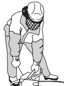
**VÝSIMNITE SI!** Šnúru štartéra nevyťahujte naplno a nepúšťajte držadlo štartéra pri plnom vytiahnutí šnúry. Môže to poškodiť stroj.
