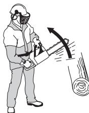
キックバックは、ガイドバーのキックバックゾーンに何かが接触したときにのみ起ります。
