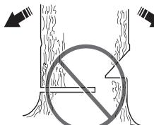
Po dokončení směrového zářezu a hlavního řezu by se strom měl začít káct samovolně nebo pomocí dřevorubeckého klínu či páčidla.
