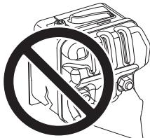
Pravidelně kontrolujte, zda je tlumič výfuku bezpečně upevněn k zařízení.
