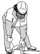
**FIGYELEM!** Ne húzza ki az indítószinort teljesen, és ne engedje el az indítófogantyút, ha a zsinór teljesen kihúzott állapotban van. Ez a gép károsodását okozhatja.
