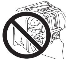
Pravidelne kontrolujte, či je tlmič výfuku pevne pripojený k motoru.
