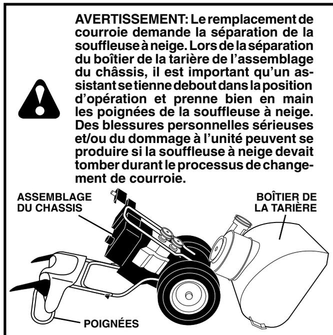
**AVERTISSEMENT:** Le remplacement de courroie demande la séparation de la souffleuse à neige. Lors de la séparation du boîtier de la tarière de l'assemblage du châssis, il est important qu'un assistant se tienne debout dans la position d'opération et prenne bien en main les poignées de la souffleuse à neige. Des blessures personnelles sérieuses et/ou du dommage à l'unité peuvent se produire si la souffleuse à neige devait tomber durant le processus de changement de courroie.
