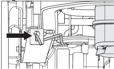
Les leviers sont situés sur chaque côté à l'arrière de l'unité, en-dessous de la plaque arrière du moteur. La tringlerie de dérivation sert à pousser ou tirer à la main l'unité. Consulter **Déplacer la machine à la main** dans la section *Utilisation*.
