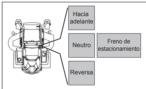
Lorsque les deux leviers sont déplacés vers l'avant ou vers l'arrière de façon similaire, la machine se déplace en ligne droite vers l'avant ou vers l'arrière.
