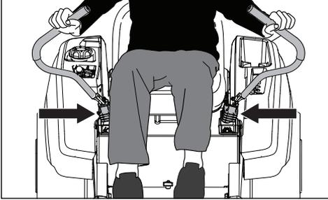
**REMARQUE :** Si les commandes de direction ne peuvent être maintenues en position complètement extérieure, il est possible de régler la tension en resserrant l'écrou derrière le pivot. (Consulter le paragraphe sur le frein de stationnement dans cette section.)
