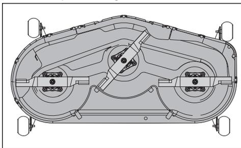
2. Mesurer de la surface du sol jusqu'au bas de la pointe de lame sur le côté de l'éjecteur de l'unité de coupe. Noter cette mesure.
