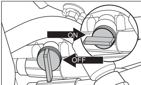
Le robinet de carburant se trouve du côté arrière gauche du siège. La valve est fermée lorsque la languette est tournée perpendiculairement à la conduite d'alimentation en carburant.
