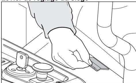
Le siège peut être réglé dans le sens de la longueur. Au moment de procéder aux réglages, le levier sous le côté droit du siège est tiré. Il est ensuite possible de déplacer le siège vers l'avant ou vers l'arrière.
