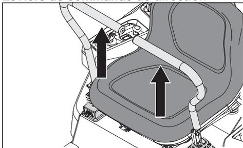
La vitesse et le sens de la marche se règlent en continu à l'aide des deux leviers de commande. Les commandes de direction peuvent être déplacées vers l'avant ou vers l'arrière à partir du point mort. Il y a de plus un point mort qui est verrouillé si les commandes de direction sont déplacées vers l'extérieur.
