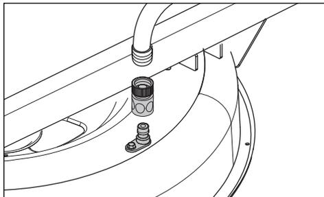
*Pour les modèles dotés d'un regard de nettoyage*, fixer le raccord rapide (de la trousse d'accessoires) à un boyau d'arrosage. Après la tonte, fixer le tuyau au regard de nettoyage et ouvrir l'eau.
