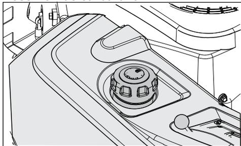
Lire les consignes de sécurité avant d'effectuer un plein de carburant. La machine comporte un réservoir de carburant se trouvant derrière la console. Le volume du réservoir est de 13,25 litres.
