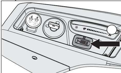
Le compteur d'entretien affiche le nombre total d'heures de fonctionnement du moteur et si le moteur et la tondeuse nécessitent un entretien courant.
