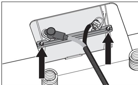
2. Utiliser deux clés 1/2 po pour débrancher le câble de batterie NOIR, puis le câble de batterie ROUGE.
