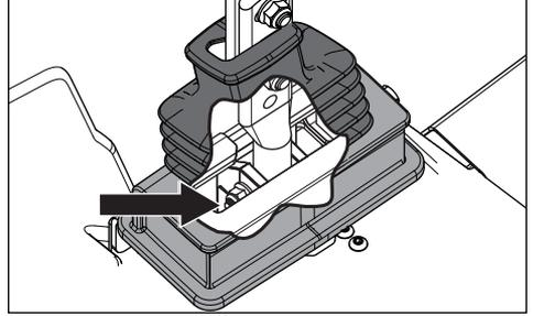
Pour régler la tension du frein de stationnement, retirer le cache qui couvre la base de commande de direction. Serrer l'écrou d' 1/2 po jusqu'à ce que la tension de freinage soit correctement ajustée. Replacer le cache en s'assurant que sa partie supérieure soit bien placée entre les deux boulons de réglage de la commande de direction.
