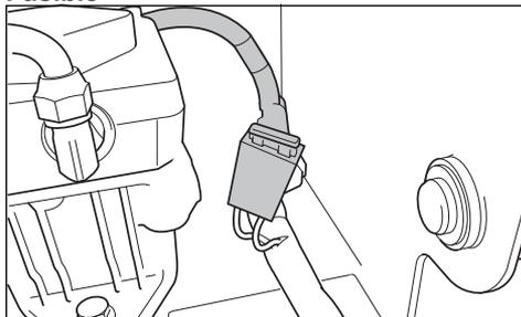
Le fusible de 20 ampères est situé sur le côté gauche de la machine. Ils sont accessibles en faisant basculer le siège vers l'avant. Il s'agit de fusibles à goupille plate du même type que celles utilisées dans les véhicules automobiles.
