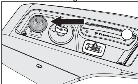
La commande d'étrangleur est utilisée lors des démarrages à froid afin d'enrichir le mélange gazeux. Pour les démarrages à froid, la commande doit être tirée.
