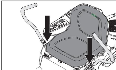
Le frein de stationnement est intégré aux leviers de commande de direction. Placez les deux leviers en position engagée pour actionner le frein de stationnement.
