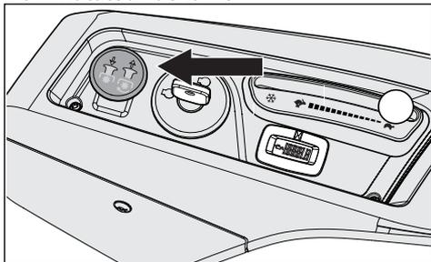
Pour engager la tête de coupe, tirer sur la molette de l'interrupteur de lame. Les lames de la tondeuse sont débrayées lorsque le bouton est enfoncé.
