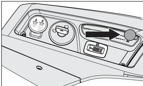
La commande de l'accélération contrôle le régime moteur et, par conséquent, le taux de rotation des lames, en supposant que le levier de commande des lames est tiré.
