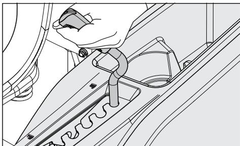
4. Placer fermement les leviers de commande de mouvement / frein de stationnement vers l'extérieur à la position verrouillée.
