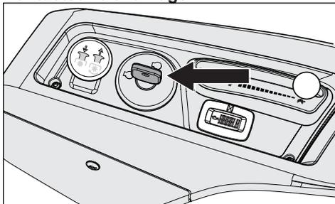
L'interrupteur d'allumage se trouve dans le panneau de commande et il sert pour le démarrage et l'arrêt du moteur. Sur les modèles équipés de phares, tourner la clé dans le sens horaire sur ACCESSORY pour les utiliser.
