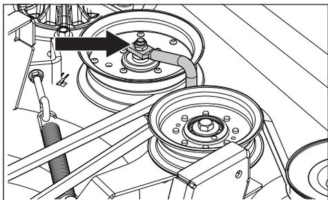
6. Pousser vers l'intérieur sur le bras de commande de ralenti pour dégager la tension sur la courroie.
