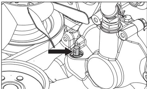
Lorsque la machine est en marche, les empreintes situées dans la soupape reposent avec leur partie avant orientée vers l'arrière. Pour utiliser la dérivation, tourner le détendeur de pompe d'un demi-tour dans n'importe quel sens. Inverser la procédure pour réinitialiser la pompe.
