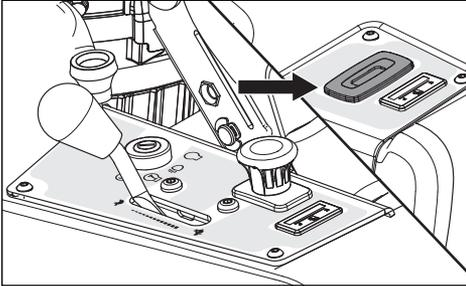
Le compteur d'entretien est situé sur le panneau de commande de gauche et affiche le nombre total d'heures de fonctionnement du moteur et si le moteur et la tondeuse nécessitent un entretien courant.
