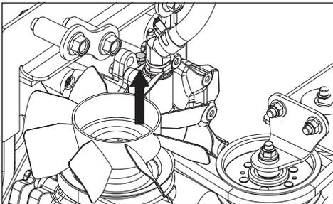
8. Remplir d'huile moteur 20W50 jusqu'à ce que l'huile apparaisse au bas de chaque port supérieur de boîte-pont (environ 1,89 l par boîte-pont, 3,78 l au total).
