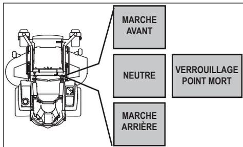
Pour tourner vers la droite par exemple durant la conduite en marche avant, déplacer le levier de commande droit vers la position point mort. La rotation de la roue droite diminue et la machine tourne vers la droite.
