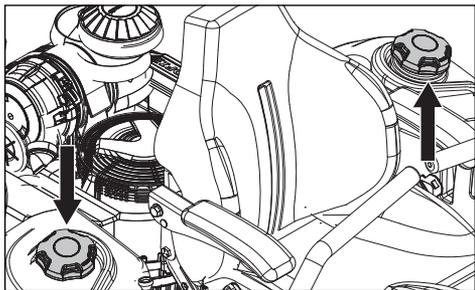
Lire les consignes de sécurité avant d'effectuer un plein de carburant. La machine est dotée de deux réservoirs de carburant, un de chaque côté derrière le siège. Chaque réservoir a une capacité de 20,8 litres.
