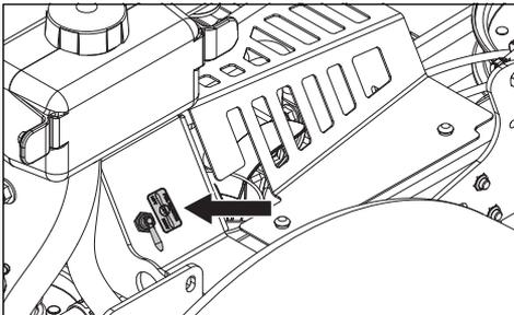
Le robinet de carburant se trouve du côté arrière droit du siège. Le robinet a trois positions : réservoir droit, réservoir gauche et OFF.
