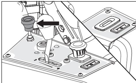
La commande d'étrangleur est utilisée lors des démarrages à froid afin d'enrichir le mélange gazeux.
