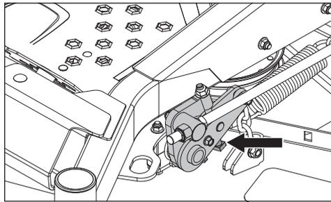
3. Tourner les deux lames extérieures pour les aligner au plateau de façon avant-arrière. Repositionner les vis de fixation arrière vers le haut ou vers le bas jusqu'à ce que l'arrière de l'unité de coupe soit de 3,175 mm à 9,525 mm plus haut à l'arrière par rapport à la mesure côte à côte.
