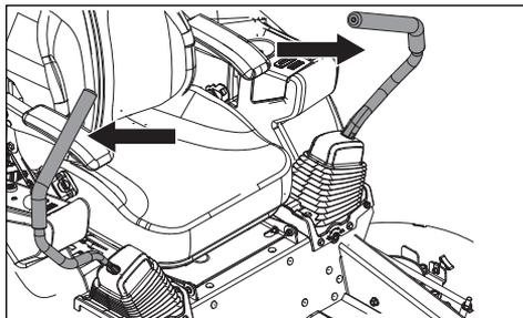
Le frein de stationnement est intégré aux leviers de commande de direction. Placer les deux leviers en position engagée pour actionner le frein de stationnement.
