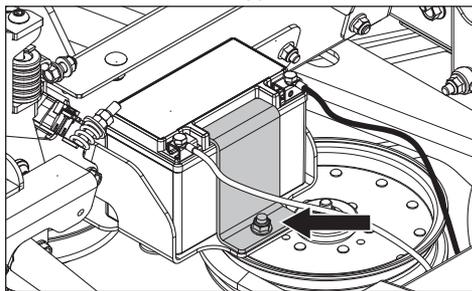
3. Utiliser deux clés 1/2 po pour débrancher le câble de batterie NOIR, puis le câble de batterie ROUGE.
