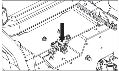
Le siège peut être tourné vers l'avant pour accéder à la batterie et aux éléments hydrauliques de la tondeuse. Appuyer le levier de verrouillage vers le bas pour libérer le siège. Relever le siège jusqu'à ce que la tige s'engage.
