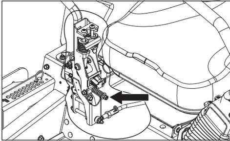
3. Pour modifier la tension du frein de stationnement, serrer le boulon de pivot jusqu'à obtenir le freinage souhaité.
