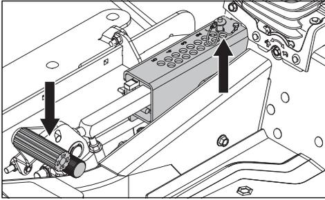
Les pédales de la hauteur de coupe soulèvent l'unité de coupe afin de permettre le réglage de l'unité de coupe à la hauteur désirée. Enfoncer la pédale de levage (inférieure) et tourner le pied pour enfoncer également la pédale de relâchement (supérieure) de manière à déverrouiller le soulèvement du plateau.
