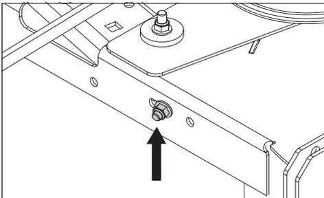
6. La tension de la courroie doit être réglée à 60-70 lb.
