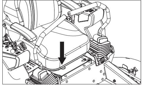
Le siège peut être réglé dans le sens de la longueur. Le levier se trouve sous le côté droit du siège. Au moment de procéder aux réglages, le levier est tiré vers la gauche.
