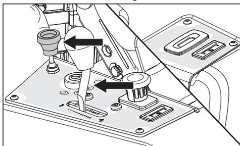
6. Ouvrir le robinet de carburant pour le réservoir sélectionné.
