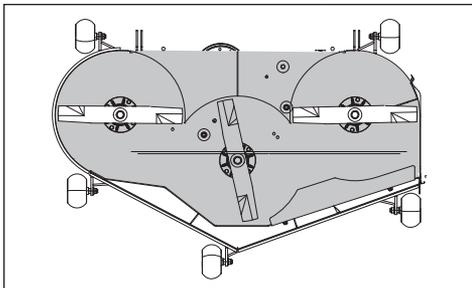
2. À partir du sol, mesurer jusqu'au bas de l'extrémité de la lame sur le côté de décharge de l'unité du plateau de la tondeuse. Retenir cette mesure. Passer de l'autre côté et vérifier si la mesure est identique. S'il est nécessaire de procéder à un réglage, desserrer le contre-écrou puis déplacer la vis de fixation vers le haut ce que les deux mesures côte à côte soient identiques. Retenir la mesure.
