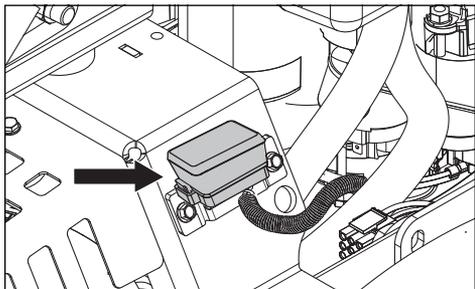
Les fusibles se trouvent du côté gauche de la machine et ils sont accessibles en faisant basculer le siège vers l'avant. Il s'agit de fusibles plats semblables à ceux utilisés dans les véhicules automobiles. Il y a trois fusibles avec des puissances et fonctions différentes, 20 A, fusible principal, 7,5 A, couplage plateau tondeuse, 10 A, accessoires.
