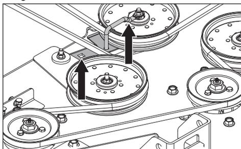
4. À l'aide d'une poignée articulée 1/2 po et en utilisant l'ouverture carrée dans le bras du tendeur, basculer le bras dans le sens antihoraire pour relâcher la tension de la courroie.
