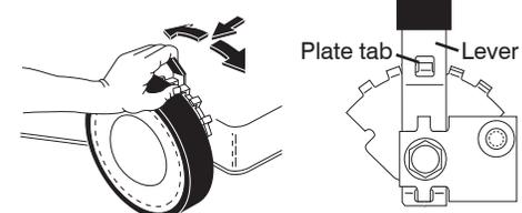
ROTATE LEVER FORWARD TO RAISE MOWER
