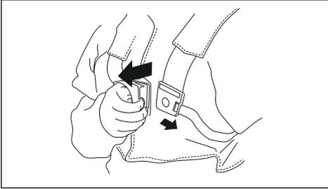
In einem Notfall hilft Ihnen die Schnelllösefunktion, das Gerät sicher zu entfernen.
