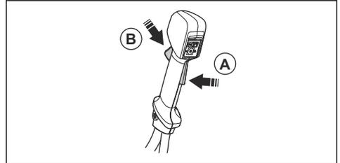
1. Kontrollieren Sie, ob der Gashebel gesperrt ist, wenn sich die Sperre in der Ausgangsloge befindet.
