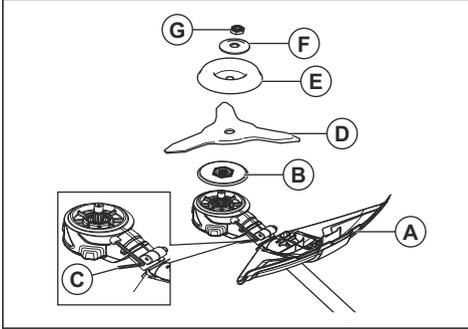
3. Namestite pogonski disk (B) na pogonsko gred.
