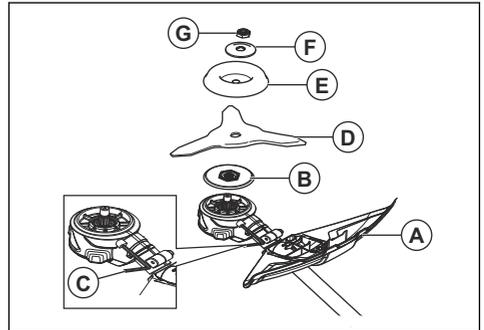
3. Montieren Sie den Mitnehmer (B) an der Abtriebswelle.
