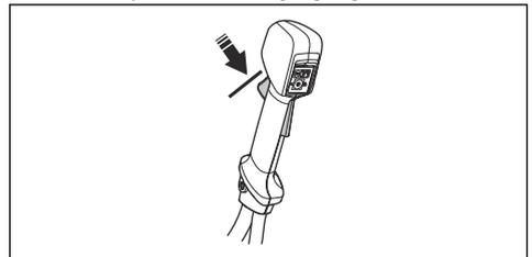
2. Die Gashebelsperre eindrücken und kontrollieren, ob sie in ihre Ausgangsloge zurückkehrt, wenn sie losgelassen wird.
