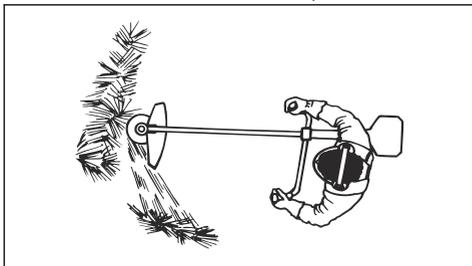
4. Med odstranjevanjem trave rezilo nagnite v levo.
