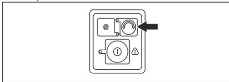
**Opomba:** Ko smer vrtenja spremenite v smer urinega kazalca, se odrezan material odstrani z noža/rezila za travo. Hitrost noža/rezila za travo se krajši čas znižuje, preden se znova začne vrtenje v nasprotni smeri urnega kazalca.
