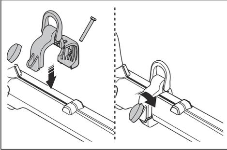
3. Schließen Sie die Enden der Schleifenhalterung an.
