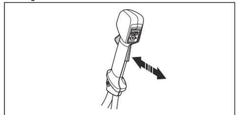
3. Prüfen Sie, ob sich der Gashebel und die Sperre frei bewegen lassen und ob die Rückolfeder ordnungsgemäß funktioniert.
