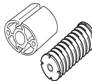
Sprawdzaj regularnie, czy elementy amortyzujące nie są pęknięte lub czy nie uległy deformacji. Sprawdź, czy elementy amortyzujące są całe i dobrze zamocowane.
