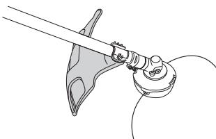
Kontrollera att skyddet är oskadat och fritt från sprickbildning. Byt skydd om det utsatts för slag eller har sprickor.
