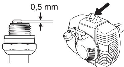
**OBS!** Använd alltid rekommenderad tändstiftstyp! Felaktigt tändstift kan förstöra kolv/cylinder. Se till att tändstiftet har s.k. radioavstörning.
