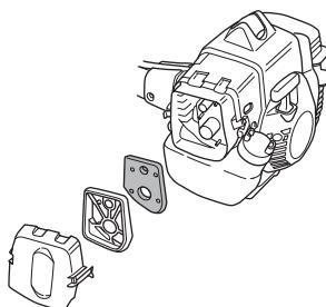
Rengør filteret efter 25 timers drift eller oftere, hvis forholdene er usædvanligt støvede.
