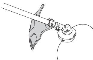
Kontroller at vernet er uskadd og fritt for sprekkdannelser. Skift vernet hvis det er blitt utsatt for slag eller har sprekker.
