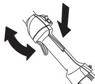
Se anvisningar under rubrik Start. Starta maskinen och ge full gas. Släpp gasreglaget och kontrollera att skärutrustningen stannar och att den förblir stillstående.
