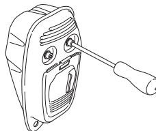
Hvis lyddemperen i maskinen er utstyrt med gnistfangernett, må dette rengjøres regelmessig. Et tilstoppet nett fører til at motoren går varm med alvorlig motorskade som følge.
