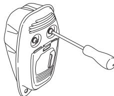
Är din maskins ljuddämpare utrustad med ett gnistfångarnät, skall detta rengöras regelbundet. Ett igaensatt nät leder till varmkörning av motorn med allvarlig motorskada som följd.
