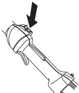
Start motoren, og kontrollér, at motoren slukkes, når stopkontakten sættes i stopposition.
