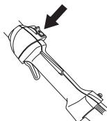
**HUOM!** Pysäytyskosketin palautuu automaattisesti käynnistysasentoon. Sen vuoksi, tahattoman käynnistykseen estämiseksi, sytytystulpansuojuksen on aina irrotettava sytytystulpasta asennuksen, tarkastuksen ja/ tai huollon ajaksi.
