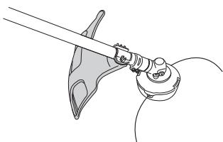
Kontrollér, at beskyttelsen er intakt og fri for revner. Udskift beskyttelsen, hvis den har været utsat for slag eller har revner.
