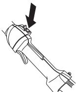
Käynnistä moottori ja tarkasta, että moottori pysähtyy, kun pysäytin siirretään pysäytysasentoon.
