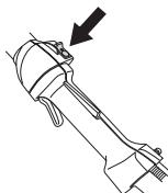
**BEMÆRK!** Stopkontakten skifter automatisk til startposition. For at undgå utilsigtet start skal tændhætten derfor altid tages af tændrøret ved montering, kontrol og/eller vedligeholdelse.
