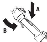
Kontrollér, at gasreguleringen er låst i tomgangsstilling, når gasreguleringslåsen befinner sig i udgangsstilling.
