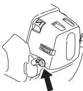
**VARNING!** När motorn startas med chokereglaget i choke- eller startgasläge börjar skärutrustningen omedelbart att rotera.
