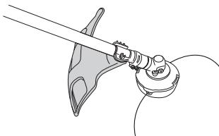
Tarkasta, että suojuS on ehjä ja ettei siinä ole halkeamia. Vaihda suojuS, jos siihin on kohdistunut iskuja tai siinä on halkeamia.
