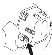
**ADVARSEL!** Når motoren startes med chokeren i choker- eller startgasstilling, begynder skæreudstyret straks at rotere.
