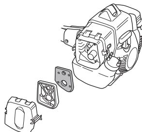
Rengjør luftfilteret etter 25 timers drift, oftere hvis maskinen brukes under forhold med usedvanlig mye stov.
