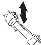
Kontroller at gassregulatoren og gassregulatorsperren går lett og at returfjærssystemet fungerer.
