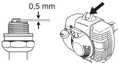
**OBS!** Bruk alltid anbefalt type tennplugg! Feil tennplugg kan ødelegge stempel/sylinder. Påse at tennpluggen har såkalt radiostøyfilter.
