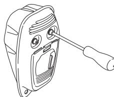
Jos koneesi äänenvaimennin on varustettu kipinänsammatusverkolla, on myös se puhdistettava säännöllisesti. Tukkeutunut verkko aiheuttaa moottorin kuumenemisen, mistä seuraa vakava moottorivaurio.
