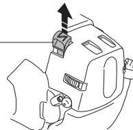
**Brennstoffpumpe:** Trykk på brennstoffpumpens gummiblære gjentatte ganger til brennstoff begynner å fylle blæren. Blæren behøver ikke å fylles helt.
