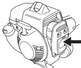
Noen lyddempere er utstyr med et spesielt gnistfangernett. Hvis maskinen er utstyr med en slik lyddemper, bør nettet rengjøres en gang i uken. Dette gjøres enklast med en stålborste. På lyddempere uten katalysator bør nettet rengjøres og eventuelt byttes en gang pr. uke. På katalysatorlyddempere skal nettet
