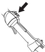
**OBS!** Stoppkontakten återgår automatiskt till startläge. För att undvika ofrivillig start, måste därför alltid tändhatten avlägsnas från tändstiftet vid montering, kontroll och/eller underhåll.
