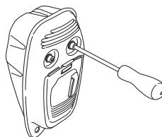
Er din maskines lyddæmper udstyret med et gnistfangernet, skal dette rengøres regelmæssigt. Et tilstoppet net medfører, at motoren kører varm med alvorlig motorskade til følge.
