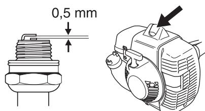
**BEMÆRK!** Brug altid anbefalet tændrørstype! Forkert tændrør kan ødelægge stempel/cylinder. Kontrollér, at tændrøret har såkaldt radiostøjdæmpning.
