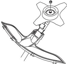
Bei der Montage die Mutter entgegen der Rotationsrichtung der Schneidausrüstung anziehen. Bei der Demontage die Mutter in der Rotationsrichtung der Schneidausrüstung lösen. (ACHTUNG! Die Mutter hat ein Linksgewinde.) Die Mutter mit dem Schlüssel für die Klingennutter anziehen.
