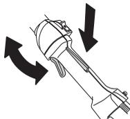
Glej poglavje pod naslovom Vžig. Vžgite stroj in mu dajte polni plin. Izpustite plinsko ročico in se prepričajte, da se rezilni priključek ustavi in obrniruje. Če se rezilni priključek vrti, ko je
