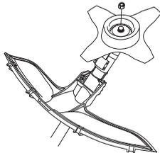
Pri montaži priključkov zategnite matico v nasprotni smeri rotacije rezilnih priključkov. Pri demontaži rezilnih priključkov zrahljate matico v smeri vrtenja. (POZOR! Matica ima levi navoj.) Matico privijte s ključem.
