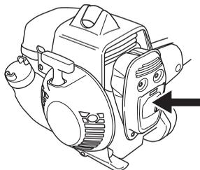
Nekateri modeli dušilcev so opremljeni s posebno mrežico za gašenje isker. Če je vaš stroj opremljen s dušilcem tega tipa, morate mrežico enkrat tedensko očistiti. V ta namen uporabljajte žično krtačo. Na dušilih brez katalizatorja je mrežico za lovljenje isker priporočljivo očistiti in po potrebi zamenjati enkrat na teden. Na dušilih s katalizatorjem preglejte in očistite mrežico za lovljenje isker enkrat na mesec.
