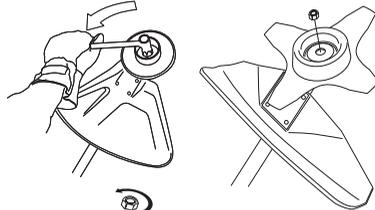
Nylonowy pierścień zabezpieczający nakrętkę przed odkręcaniem się nie powinien być starty do tego stopnia, aby można było przykręcić nakrętkę ręcznie. Zabezpieczenie to powinno wymagać siły przykręcania równej co najmniej 1,5 Nm. Po około dziesięciokrotnym przykręcaniu nakrętki należy wymienić ją na nową.
