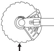
w którym należy operować kluczem nasadowym przy odpowiednio odkręcaniu i dokręcaniu nakrętki.
