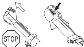
Nastartujte motor a zkontrolujte, zda se motor zastaví při přesunutí vypínače zapalování do vypnuté polohy.
