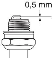
**VAROVÁNÍ!** Vždy používejte doporučený typ zapalovacích svíček! Použití jiného typu zapalovacích svíček by mohlo poškodit píst či válec. Dbejte na to, aby svíčka měla tzv. radiové odrušení.
