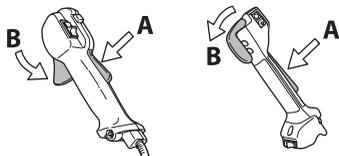
Presvedčte sa, či je ovládanie plynu zablokované pri nastavení na voľnobeh, keď je poistná páčka plynu uvoľnená.
