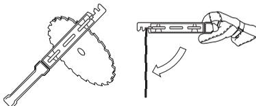
Kontrolujte řezné vybavení co do poškození a vzniku trhlinek. Poškozené řezné vybavení je nutné vždy vyměnit.
