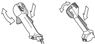
Vyhľadajte si inštrukcie v odseku Štart. Naštartujte stroj a pridajte na plný plyn. Uberte plyn a skontrolujte, či sa rezací nástroj zastavil a či potom zostal stáť. Pokiaľ rezací nástroj rotuje aj pri chode stroja na voľnobeh, potom treba
