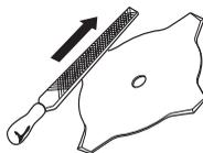
Udržiavajte správny tvar (rozvádzanie) zubov noža! Postupujte podľa našich inštrukcií a používajte odporúčané náradie na vytváranie rozvádzania zubov („šranku“). Akékoľvek nesprávne urobené rozvádzanie zubov pilového kotúča zvyšuje riziko jeho zaseknutia, vzpriechenia alebo spätného rázu a následného poškodenia kotúča.
