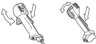
Viz pokyny pod rubrikou Start. Nastartujte stroj a dejte plný plyn. Uvolněte regláž plynu a přesvědčte se o tom, že se řezné vybavení zastavilo a stojí v klidu. Pokud se po převedení regláže plynu do polohy volnoběhu řezné vybavení nadále
