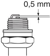
**UPOZORNENIE!** Vždy používajte odporúčaný typ zapaľovacej sviečky! Nesprávna zapaľovacia sviečka môže vážne poškodiť piest/valec. Skontrolujte, či je zapaľovacia sviečka správne nasadená.
