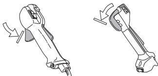
Wciśnij blokadę dźwigni gazu i sprawdź, czy po zwolnieniu nacisku powraca ona do położenia wyjściowego.
