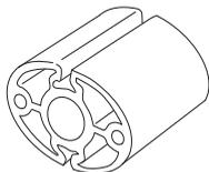
Sprawdzaj regularnie, czy elementy amortyzujące nie są pęknięte lub czy nie uległy deformacji. Sprawdź, czy elementy amortyzujące są całe i dobrze zamocowane.
