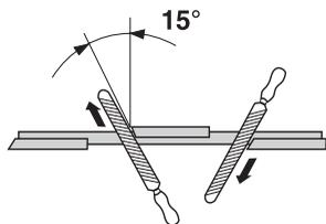
Upravte rozvádzanie zubov. Šírka rozvádzania má byť 1 mm.
