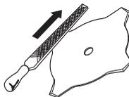
A fűrészpenge élezését helyesen végezze. Kövesse előírásainkat és a javasolt élező szerszámot használja. A hibásan élezett penge növeli az elakadás, a visszarúgás, valamint a fűrészpenge sérülésének veszélyét.
