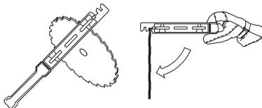
Skontrolujte rezačím kotúč, či na ňom nie sú viditeľné známky poškodenia alebo trhliny. Poškodený rezačím nástroj treba vždy vymeniť.
