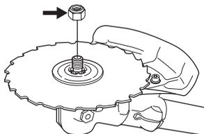
Összeszerelésnél a csavaranyát a vágófelszerelés forgásával ellentétes irányban csavarva húzza meg. Szétszerelésnél a csavaranyát a vágófelszerelés forgásának megfelelő irányban csavarva húzza meg. (FIGYELEM! A csavar balmenetes.) A csavaranya meglazítása és meghúzása során a fűrészfogak felsérthetik a kezét. Ezért kezeit e munka során tartsa a pengevédő védelmében. Hogy ez lehetővé váljon, használjon
