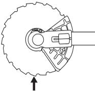
Při povolení a dotahování matice pilového kotouče může dojít k poranění rukou o zuby kotouče. Proto se snažte držet ruku při práci za krytem kotouče. Použijte vždy trubkový klíč s dostatečně dlouhou násadou, abyste toto umožnili. Šípka na
