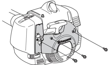
Zdemontuj filtr powietrza maszyny i pokrywę filtra powietrza. Załóż filtr powietrza i pokrywę filtra powietrza znajdujące się w zestawie zimowym.
