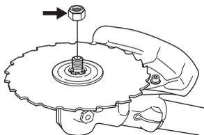
Při montáži utáhněte matici proti směru otáčení řezného vybavení. Při demontáži povolte matici ve směru otáčení řezného vybavení. (POZOR! Matice je levotočivá.) Při povolování a dotahování matice pilového kotouče může dojít k poranění rukou o zuby kotouče. Proto se snažte držet ruku při práci za krytem kotouče. Použijte vždy trubkový klíč s dostatečně dlouhou násadou, abyste toto umožnili. Šipka na obrázku
