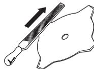
Dopilnuj, aby zęby tarczy tnącej były prawidłowo rozwarte! Postępuj zgodnie z naszymi instrukcjami i stosuj zalecany rozwieracz. Nieprawidłowe rozwarcie zębów tarczy tnącej zwiększa ryzyko jej zakleszczenia się, odbicia oraz uszkodzenia.
