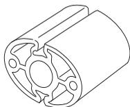
Pravidelne kontrolujte tlmiče vibrácií, či nie sú prasknuté alebo deformované. Skontrolujte, či nie je tlmič vibrácií poškodený a či je bezpečne pripevnený.
