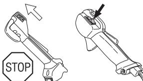
Włącz silnik i sprawdź, czy po przesunięciu wyłącznika w położenie stop silnik zatrzyma się.
