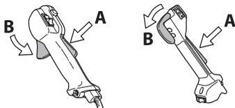
Zkontrolujte, zda při uvolnění pojistky páčky plynu zapadne páčka plynu do polohy, při které je motor ve volnoběžných otáčkách.
