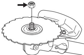
Pri upínaní utáhnite maticu v opačnom smere, ako je smer otáčania nástroja. Pri uvoľňovaní otáčajte maticu v rovnakom smere, ako je smer otáčania nástroja. (UPOZORNENIE! Matica má ľavý závit.) Pri uvoľňovaní a pri utáňovaní upínacej matice rezacieho noža vzniká riziko poranenia rezacími zubami noža. Pri takej práci preto musíte zabezpečiť, aby vaše ruky boli neustále chránené krytom noža. Vždy používajte nástrčkový kľúč z náradia. Šípky na obrázku ukazujú na miesto, kde treba
