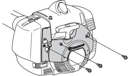
Odstraňte vzduchový filtr a kryt vzduchového filtru ze stroje. Upevněte vzduchový filtr a kryt vzduchového filtru, které jsou součástí zimní sounpravy.
