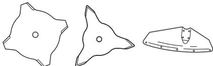
Ostrza rozdrabniacza przeznaczone są do koszenia bujnej trawy oraz krzewów.
