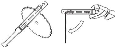
Ellenőrizze, hogy a vágófelszerelés nem sérült-e, nincs-e rajta repedés. A sérült vágófelszerelést mindig ki kell cserélni.
