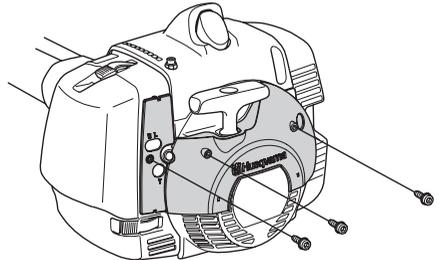
Odstráňte zo stroja vzduchový filter a kryt vzduchového filtra. Nasadte vzduchový filter a kryt vzduchového filtra dodaný so zimnou súpravou.
