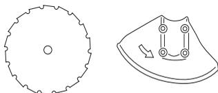
A fűpenge és a fűkés durvább típusú fű eltávolítására való.
