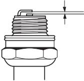
**OBS!** Använd alltid rekommenderad tändstiftstyp! Felaktigt tändstift kan förstöra kolv/cylinder. Se till att tändstiftet har s.k. radioavstörning.
