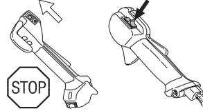
Käynnistä moottori ja tarkasta, että moottori pysähtyy, kun pysäytin siirretään pysäytysasentoon.
