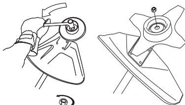
Låsmutterns nylonlåsning får ej vara så sliten att den kan skruvas med fingrarna. Låsningen ska hålla minst 1,5
