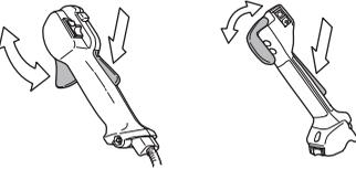
Katso otsikon Käynnistys alla annetut ohjeet. Käynnistä kone ja anna täysi kaasu. Löysää kaasuliipasim ja tarkasta, että terälaite pysähtyy ja pysyy liikkumattomana. Jos terälaite pyörii, kun kaasuliipasim on joutokäyntiasennossa, on kaasuttimen joutokäyntisäätö tarkastettava. Katso otsikon Kunnossapito alla annetut ohjeet.
