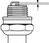
**BEMÆRK!** Brug altid anbefalet tændrørstype! Forkert tændrør kan ødelægge stempel/cylinder. Kontrollér, at tændrøret har såkaldt radiostøjdæmpning.
