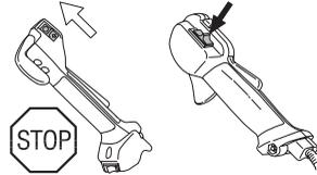
Start motoren og kontrollér at motoren blir slått av når stoppbryteren føres til stoppstilling.
