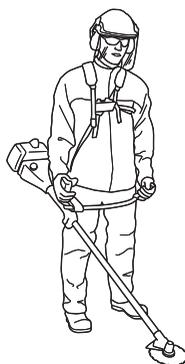
8 Ved arbejde med rydningssav skal den altid hægte fast i selen. I modsat fald kan du ikke manøvrere rydningsraven sikkert, og dette kan forårsage skade på dig selv eller andre. Brug aldrig en sele med defekt snapudløsning.
