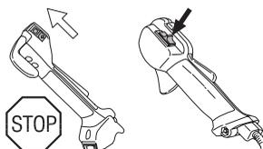
Start motoren, og kontrollér, at motoren slukkes, når stopkontakten sættes i stopposition.
