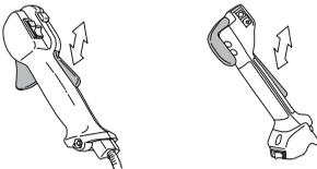
Kontroller at gassregulatoren og gassregulatorsperren går lett og at returfjærsystemet fungerer.
