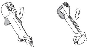
Kontrollera att gasreglaget och gasreglagespärren går lätt samt att deras retur fjäder system fungerar.
