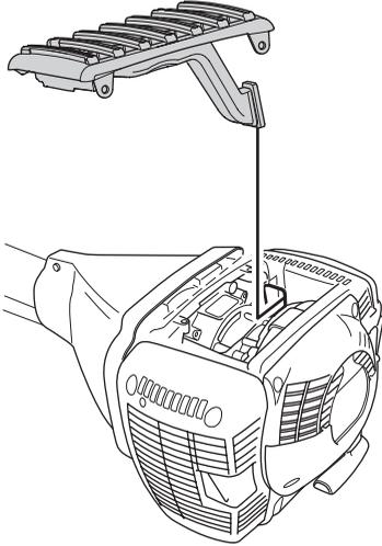
**TÄRKEÄÄ!** Koneeta rakenne ON palautettava normaaliiksi, jos lämpötila on yli -5°C tai 0°C. Muussa tapauksessa moottori voi ylikuumeta ja vaurioitua vakavasti.
