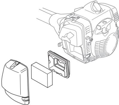
Se till att filtret är torrt då det åter monteras.
