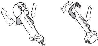
Se anvisninger under overskriften Start. Start maskinen og gi full gass. Slipp gassregulatoren og kontrollér at skjæreutstyret stanser og at det blir stående stille. Hvis skjæreutstyret roterer når gassregulatoren står i tomgangsstilling må forgasserens tomgangsjustering kontrolleres. Se anvisninger under overskriften Vedlikehold.
