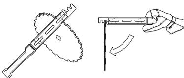
Kontroller skjæreutstyret med henblikk på skader og sprekkdannelse. Skadet skjæreutstyr må alltid skiftes.
