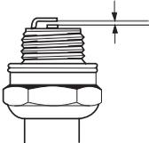
**OBS!** Bruk alltid anbefalt type tennplugg! Feil tennplugg kan ødelegge stempel/sylinder. Påse at tennpluggen har såkalt radiostøyfilter.
