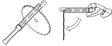
Tarkasta terälaite vaurioiden ja halkeamien varalta. Vaurioitunut terälaite on aina vaihdettava.
