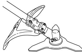
Kontroller at vernet er uskadd og fritt for sprekkdannelse. Skift vernet hvis det er blitt utsatt for slag eller har sprekker.
