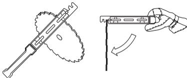
Kontrollér skæreudstyret med hensyn til skader og revnedannelse. Et beskadiget skæreudstyr skal altid udskiftes.
