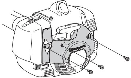
Demonter maskinens luftfilter og luftfilterlokk. Monter det luftfilteret og luftfilterlokket som følger med vintrasett.
