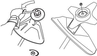
Lukitusmutterin nailonlukitus ei saa olla niin kulunut, että sitä voi ruuvata käsin. Lukituksen on kestättävä vähintään 1,5 Nm. Mutteri on vaihdettava, kun se on ruuvattu kiinni noin 10 kertaa.
