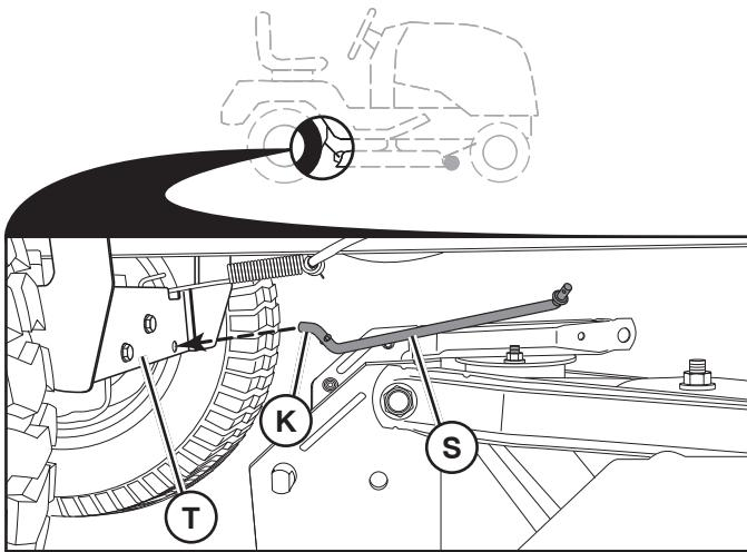
**HINWEIS:** Je nach Modell kann die Halterung (T) von der in der Abbildung gezeigten abweichen. Die Bohrung für die Stabilisatorstange befindet sich jedoch in derselben Position.
