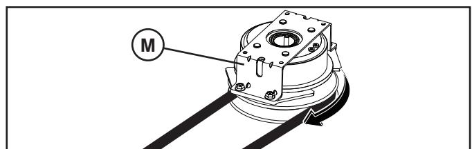
**IMPORTANTE: controllare che la cinghia scorra correttamente in tutte le scanalature della puleggia del rasaerba.**
