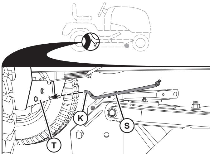
**OPMERKING:** Afhankelijk van het model kan de beugel (T) afwijken van de tekening, maar de opening voor de antizwenkbalk bevindt zich op dezelfde stand/locatie
