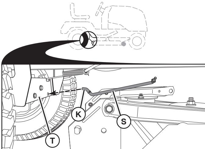
**NOTA:** Dependiendo del modelo, el soporte (T) puede ser distinto del que aparece en la ilustración, aunque el orificio de la barra antibalancéo se encuentra en la misma ubicación.
