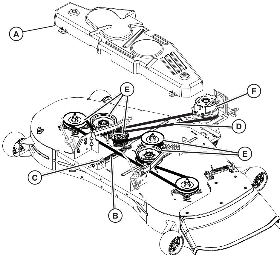
**(IT) Sostituzione della cinghia di trasmissione della lama di taglio**
