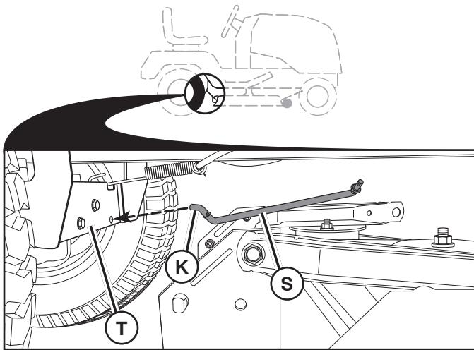
**NOTA:** a seconda del modello, la staffa (t) può essere diversa da quella indicata, ma il foro per la barra anti-oscillazione si trova nella medesima posizione.
