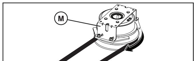
**WICHTIG:** Überprüfen Sie die genaue Verlegung des Riemens in allen Nuten der Riemenscheibe des Mähwerks.
