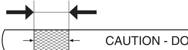
(CZ) Hladina by se měla nacházet mezi dvěma značkami na měrce. V případě potřeby dopříte olej tak, aby hladina dosáhla na horní okraj mřížované značky na měrce. Pro přibližný objem a typ oleje viz část „SPECIFIKAČE PRODUKTU“ této příručky. Nepřeplňujte.
