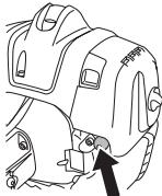
gassregulatoren og gassregulatoren, og deretter startgassknappen. Nå er startgassfunksjonen aktivert. For å tilbakestille motoren til tomgang, trykkes sperren for gassregulatoren og gassregulatoren inn.
