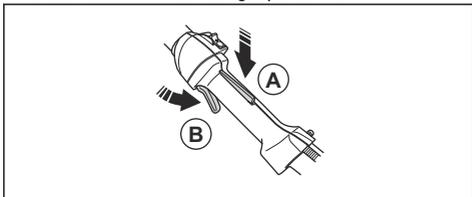
2. Stellen Sie sicher, dass der Gashebel in der Leerlaufstellung verriegelt ist, wenn die Gashebelsperre gelöst wird.
