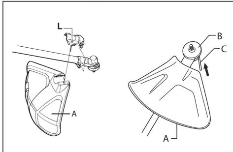
4. Namestite pogonski disk (B) na pogonsko gred.
