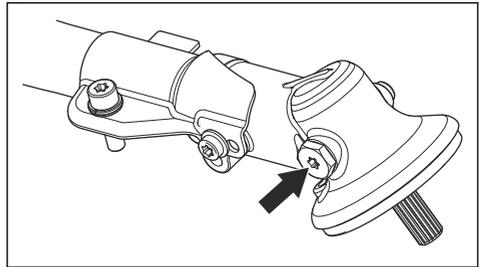
Das Fett im Getriebegehäuse muss nur bei evtl. Reparaturen gewechselt zu werden.
