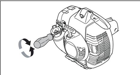
2. Drehen Sie die Einstellschraube gegen den Uhrzeigersinn, bis die Schneidusrüstung stehen bleibt.
