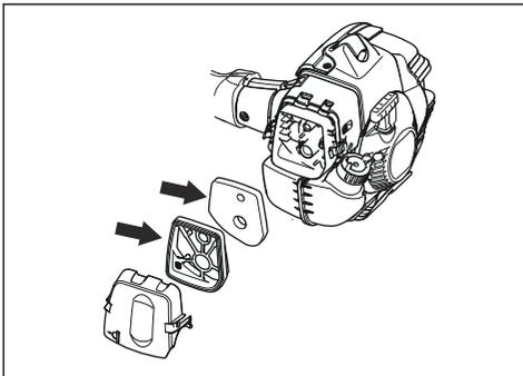
3. Reinigen Sie den Luftfilter mit warmer Seifenlauge. Achten Sie darauf, dass der Luftfilter trocken ist, bevor Sie ihn wieder einbauen.
