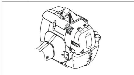
2. Odstranite pokrov zračnega filtra in zračni filter.
