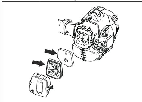
3. Zračni filter očistite s toplo milnico. Počakajte, da se zračni filter posuši, preden ga znova namestite.
