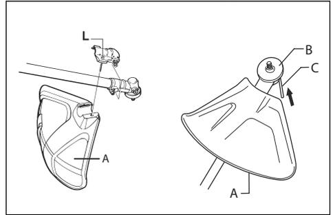
4. Montieren Sie den Mitnehmer (B) an der Abtriebswelle.
