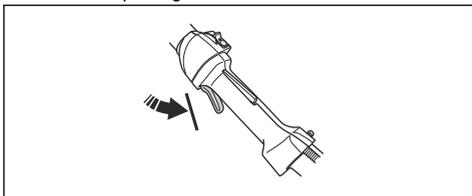
3. Drücken Sie die Gashebelsperre nach unten und kontrollieren Sie, ob sie in die Standardstellung zurückkehrt, wenn sie losgelassen wird.
