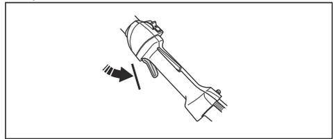
3. Pritisnite zaklep ročice plina in ročico plina ter se prepričajte, da se po sprostitvi vrne v izhodiščni položaj.
