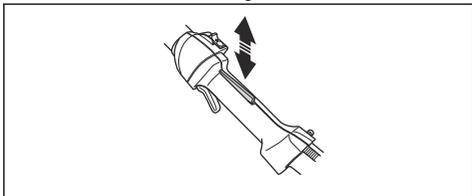
4. Kontrollieren, ob Gashebel und Gashebelsperre mit dem dazugehörigen Rückzugfedersystem leicht funktionieren.
