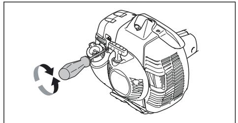
2. Vijak za prilaganje obračajte v nasprotni smeri vrtenja urinih kazalcev, dokler se rezalni priključek ne ustavi.
