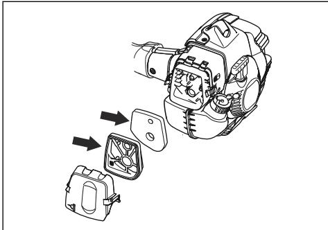
3. Nettoyez le filtre à air avec de l'eau chaude savonneuse. Assurez-vous que le filtre à air est sec avant de l'installer.
