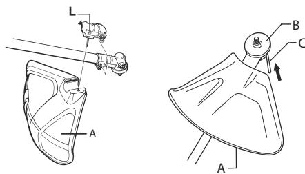
4. Montieren Sie den Mitnehmer (B) an der Abtriebswelle.
