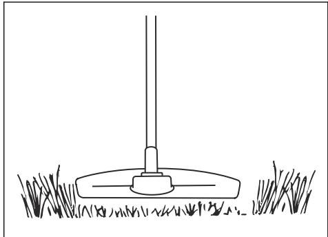
2. Drücken Sie den Trimmerkopf nicht auf den Boden. Der Boden und das Gerät könnten dadurch beschädigt werden.
