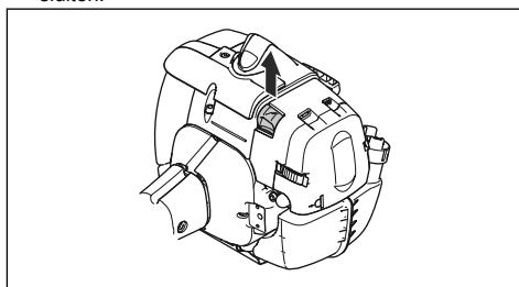
2. Verwijder het luchtfILTERdeksel en verwijder het luchtfILTER.
