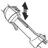
4. Contrôlez la commande d'accélération et le blocage de la gâchette d'accélération pour vérifier qu'elles se déplacent librement et que les ressorts du rappel fonctionnent correctement.
