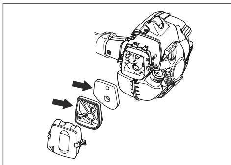
3. Reinig het luchtfILTER met een warm sopje van water en zeep. Zorg dat het luchtfILTER droog is wanneer u dit aanbrengt.
