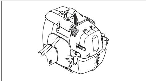
2. Retirez le couvercle du filtre à air et le filtre à air.
