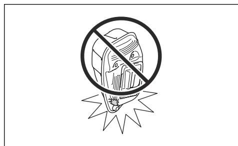
Le silencieux est conçu pour réduire au maximum le niveau sonore et rejeter les gaz d'échappement loin de l'utilisateur. En ce qui concerne le silencieux, il importe de bien suivre les instructions de contrôle, de maintenance et d'entretien.
