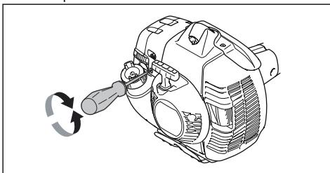
2. Tournez la vis de réglage T dans le sens contraire des aiguilles d'une montre jusqu'à l'arrêt de l'équipement de coupe.
