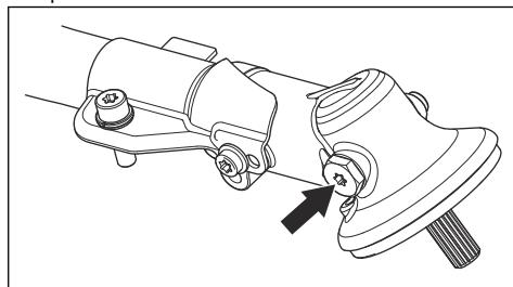
Il n'est pas nécessaire de remplacer la graisse du renvoi d'angle, sauf en cas de réparations.
