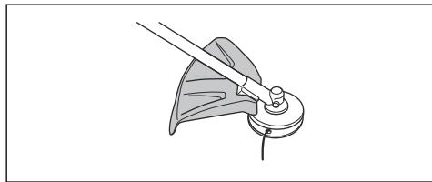
1. Réalisez un contrôle visuel pour détecter les dommages, par exemple des fissures.
