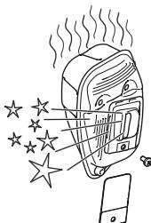
**ACHTUNG:** Wenn das Funkenfängernetz häufig verstopft ist, kann dies ein Zeichen dafür sein, dass der Katalysator nicht einwandfrei arbeitet. Lassen Sie den Schalldämpfer von Ihrem Servicehändler kontrollieren. Ein verstopftes Funkenfängernetz kann zu Überhitzung führen, wodurch Schäden an Zylinder und Kolben entstehen können.
