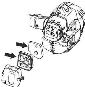
3. Reinigen Sie den Luftfilter mit warmer Seifenlauge. Achten Sie darauf, dass der Luftfilter trocken ist, bevor Sie ihn wieder einbauen.
