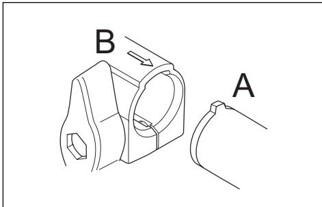
3. Drücken Sie das Ansatzstück bis zum Einrasten in die Kupplung.
