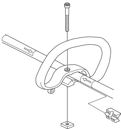
2. Schuif het afstandsstuk in de sleuf in het loophandvat.
