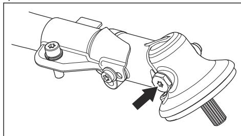
Het vet in de hoekoverbrenging hoeft niet te worden vervangen, tenzij reparaties worden uitgevoerd.
