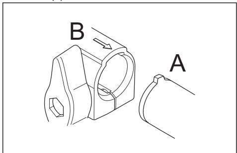
3. Poussez la fixation dans le raccord jusqu'à ce qu'un déclic indique qu'elle est bien en place.
