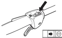
Vžgite motor in preverite, če se ustavi, ko izklopno stikalo potisnete v položaj STOP.
