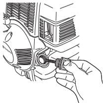
Če je nivo olja prenizek, rezervoar do vrha napolnite z motornim oljem.
