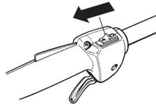
**Choke:** Den Chokehebel in Choke-Lage führen.
