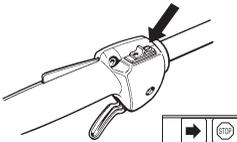
Den Motor starten und kontrollieren, ob der Motor stoppt, wenn der Stopschalter in Stoppstellung geführt wird.
