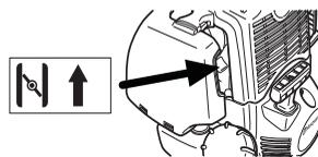
**Kraftstoffpumpe:** Mehrmals auf die Gummibläse der Kraftstoffpumpe drücken, bis diese sich mit Kraftstoff zu füllen beginnt. Die Blase braucht nicht ganz gefüllt zu werden.
