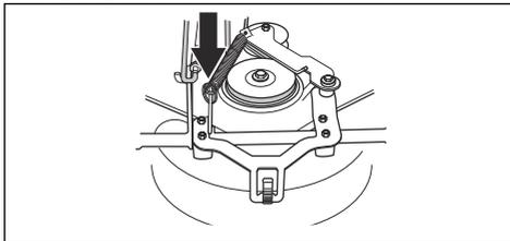
7. Umieścić zaczep sprężyny w uchwycie na ramieniu naprężającym paska napędowego.
