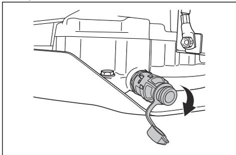
2. Pro usnadnění vypouštění oleje bez vylití nasadte na konec vypouštěcí zátky oleje například plastovou hadici.
