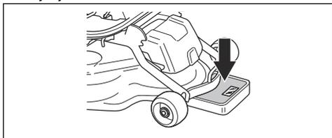
5. Medzi rám a váhu položte drevený kváder, aby ste mali istotu, že žiadnu váhu nenesú oporné kolieska.
