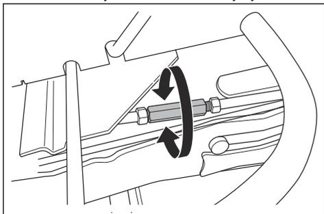
5. Po provedení seřízení utáhněte matice zvedací podpěry.
