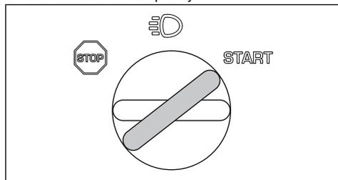
**Povšimněte si:** Nezapínejte startér na déle než 5 sekund. Pokud motor nespustí, před dalším pokusem počkejte 15 sekund.
