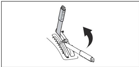
Aby obniżyć zespół tnący do położenia koszenia, nacisnąć przycisk blokady i przestawić dźwignię regulacji wysokości do przodu. Jeśli silnik jest włączony, noże zaczną się obracać automatycznie.
