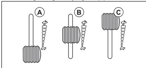
**Megjegyzés:** Megterheli a hajtószíjakat, ha a késeket a motor teljes fordulatszám mellett kapcsolja be. Ne alkalmazzon teljes gázt, amíg a vágóasztalt le nem engedte fűnyírási helyzetbe.
