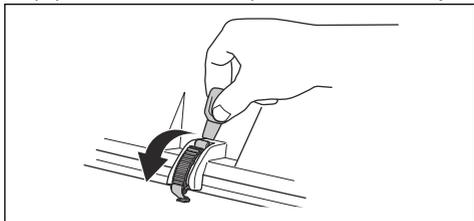
5. Zvedněte podpěru výšky sečení a vložte ji do držáku pro podpěru výšky sečení.
