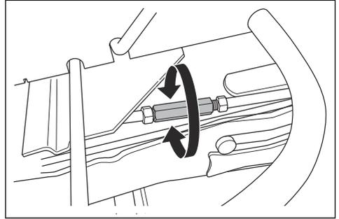
5. Dokręcić nakrętki na podporze podnoszącej po wykonaniu regulacji.
