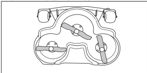
3. Dotáhněte šrouby nožů utahovacím momentem 45–50 Nm.
