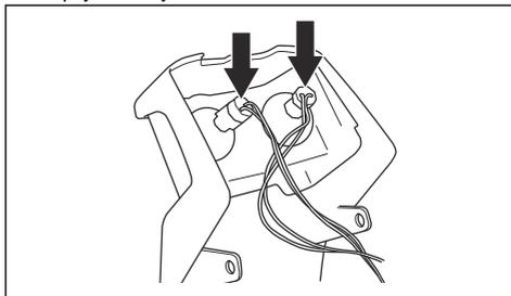
4. Vložte novou žárovku do dolního otvoru v pouzdře světel. Použijte typ žárovky uvedený v části *Technické údaje na strani 96*.
