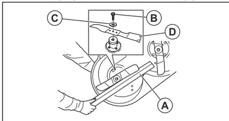
3. Uvoľnite a demontujte skrutku čepel (B), podložku (C) a čepeľ (D).
