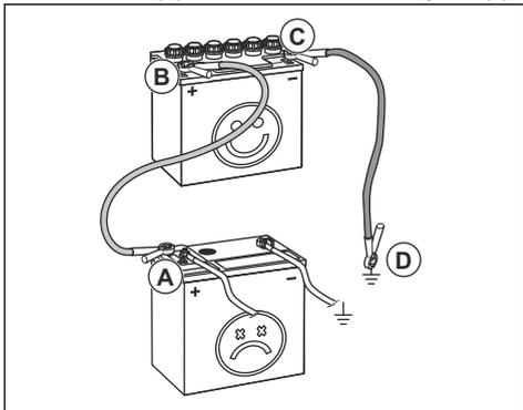
4. Csatlakoztassa a piros kábel másik végét a teljesen feltöltött akkumulátor (B) POZITÍV akkumulátorsarujához (+).
