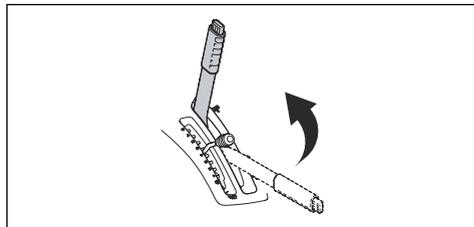
A vágóasztal fűnyírási pozícióba történő leengedéséhez nyomja meg a rögzítőgombot, és állítsa előre az emelőkart. Járó motor esetén a kések automatikusan fogorni kezdenek.
