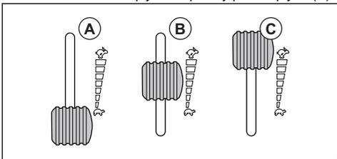
**Poznámka:** Aktivovaním čepeľí pri maximálnych otáčkach motora sa namáhajú hnacie remene. Plný plyn
