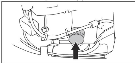
2. Delikatnie nasmarować gumową uszczelkę na nowym filtrze oleju za pomocą nowego oleju.
