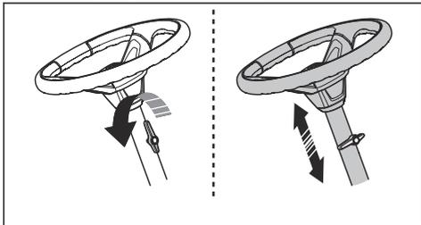
2. Wyregulować wysokość kierownicy. Prawidłowa wysokość jest następująca: podczas trzymania kierownicy ramię operatora powinno być ustawione pod kątem 90 stopni.
