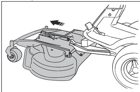
3. Emelje fel a vágóasztalt függőleges helyzetbe, amíg kattánó hangot nem ad. A vágóasztal automatikusan függőleges helyzetben rögzül.
