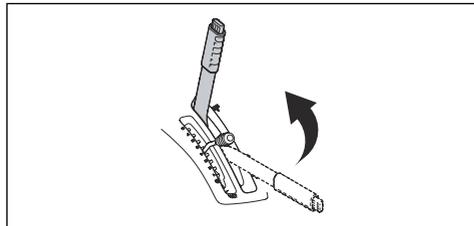
Na spustenie kosiaceho zariadenia do polohy kosenia stlačte poisťné tlačidlo a posuňte zdvíhaciu páku dopredu. Ak motor beží, čepele sa automaticky začnú otáčať.
