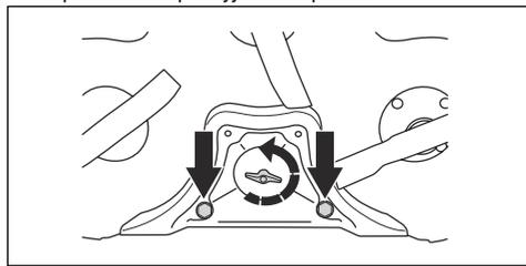
3. Uveďte žací ústrojí zpět do sekací polohy.
