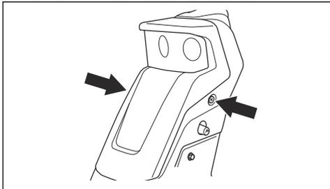
2. Odłączyć przewody od uszkodzonej lampy.
