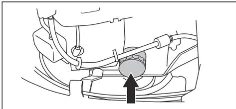
2. Gumené tesnenie na novom olejovom filtri mierne namažte novým olejom.
