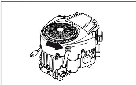
4. Zetrzeć olej z prętowego wskaźnika poziomu oleju.
