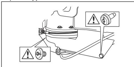
2. Nasmarować za pomocą smarownicy tłokowej przez smarowniczkę po prawej stronie, pod dolnym kołem pasowym. Smarować do momentu, aż smar zostanie wypchnięty z tyłu smarowniczki.
