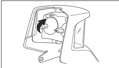
2. Odpojte kabely z prasklé žárovky.
