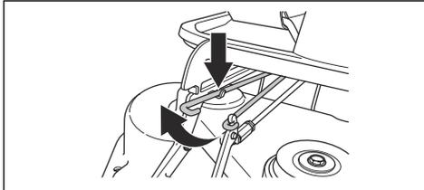
6. Pociągnąć zaczepy sprężyny, aby poluzować sprężynę naprężającą pasek napędowy.
