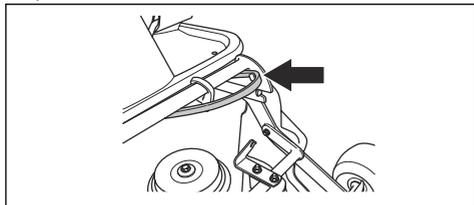
9. Umieścić drewniany klocek pomiędzy ramą urządzenia a podwoziem. Zapewnia to ochronę przed odskoczeniem zespołu tnącego podczas wyjmowania.
