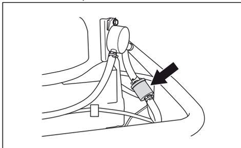
4. Ztlačte nový palivový filtr do konců hadic. Naneste kapalný čisticí prostředek na konce palivového filtru, aby se usnadnilo připojení.
