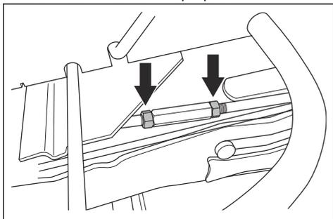
4. Otočte zvedací podpěru na stojan nebo ji zkrátte. Vysunutím stojanu zvednete zadní okraj krytu. Zkrácením stojanu snížíte zadní okraj krytu.
