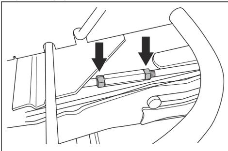
4. Obrócić podporę podnoszącą, aby wydłużyć lub skrócić ogranicznik. Wydłużyć ogranicznik, aby podnieść tylną krawędź pokrywy. Skrócić ogranicznik, aby obniżyć tylną krawędź pokrywy.
