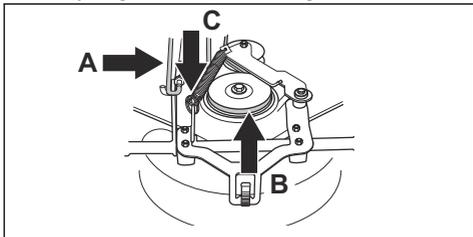
5. Umieścić pasek napędowy (B) w odpowiednim położeniu.
