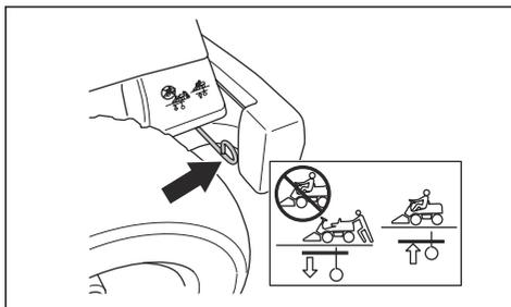
W modelu R 216T AWD dźwignia układu napędowego dla osi przedniej znajduje się za przednim lewym kołem.
