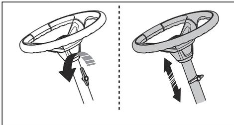
2. Nastavte výšku volantu Správnu výšku dosiahnete vtedy, keď pri držaní volantu je rameno v uhle 90 stupňov.
