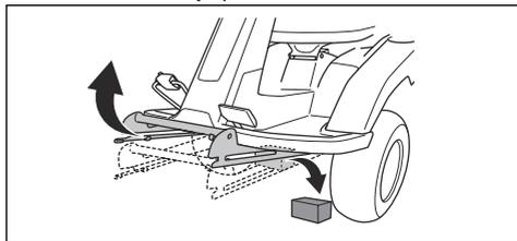
13. Žací ústrojí instalujte v opačném pořadí.
