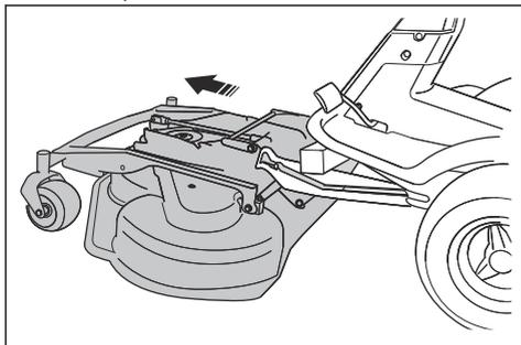
3. Zdvíhajte kosiace zariadenie do vertikálnej polohy, kým nezaznie cvaknutie. Kosiace zariadenie sa automaticky uzamkne vo vertikálnej polohe.
