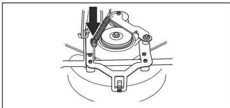
7. Vložte oko pružiny do držáku na napínací rameno hnacího řemenu.
