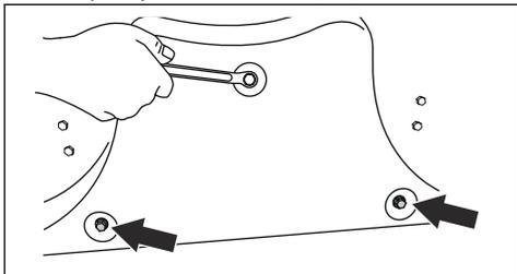
3. Do otvorov na uchytenie zarážky BioClip zaskrutkujte 3 skrutky typu M8x15 mm, aby sa predišlo poškodeniu závitov.
