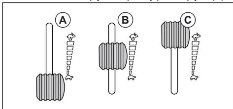
**Povšimněte si:** Zapojení nožů při plných otáčkách motoru způsobuje nápor na hnací řemen. Nepoužívejte plný plyn, dokud není žací ústrojí spuštěno do sekací polohy.
