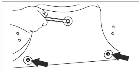
3. Upevněte 3 šrouby M8x15 mm do otvorů pro šrouby ucpávky BioClip, aby se zabránilo poškození závitů.
