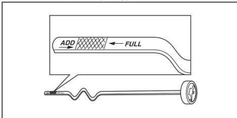
8. Wlać olej przez otwór, w którym umieszczony jest prętowy wskaźnik poziomu oleju. Uzupełniać poziom oleju powoli.
