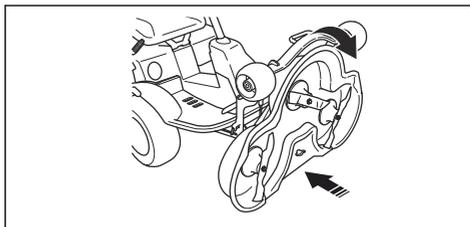
4. Zdvihnute poistku výšky rezu (A) z držiaka poistky a vložte ju do otvoru.
