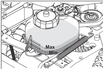
4. Doplňte motorový olej, ak je hladina oleja pod spodnou čiarou, ale nepreplňajte nad hornú čiaru. Odporúčané oleje sú uvedené v časti *Technické údaje na strane 128*.
