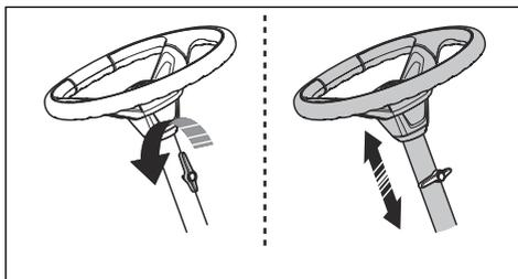
2. Upravte výšku volantu. Volant se nachází ve správné výšce, když při jeho držení máte ruku pod úhlem 90 stupňů.
