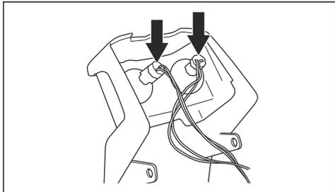
3. Óvatosan nyomja be a rögzítőszerkezetet, majd döntse meg a lámpát, és vegye ki a tartójából.
