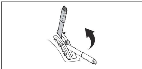
Chcete-li spustit žací ústrojí do sekací polohy, stiskněte pojistné tlačítko a posuňte zvedací páku dopředu. Pokud je motor spuštěný, nože se automaticky začnou otáčet.
