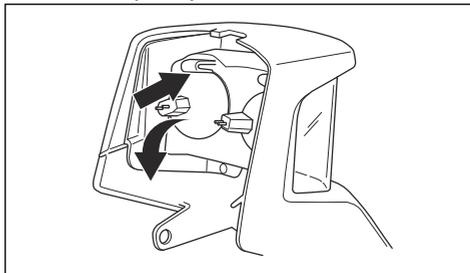
4. Vložte novú žiarovku do dolnej zásuvky na svetlomete. Použite typ žiarovky uvedený v časti *Technické údaje na strane 128*.
