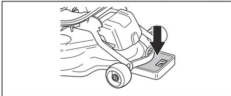
5. Aby bylo zajištěno, že nebude na opěrná kola působit žádná zátěž, vložte dřevěný špalek mezi rám a osobní váhu.
