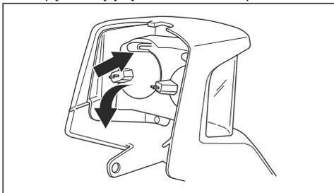
4. Włożyć nową lampę w dolne mocowanie na obudowie lampy. Użyć typu lampy według instrukcji w części *Dane techniczne na stronie 64*.
