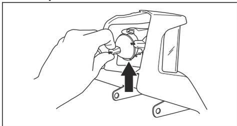
5. Nyomja be a lámpát a rögzítőszerkezetbe.
