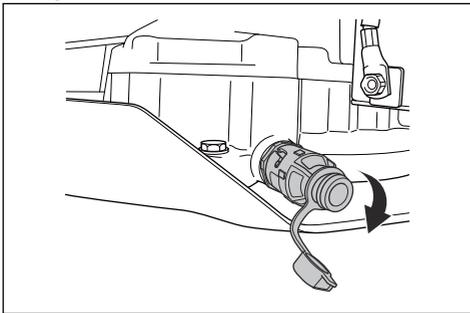
2. Az olaj kifiröccsenés nélküli leeresztésének megkönnyítésére kapcsoljon például műanyag tömlőt az olajleeresztő csavar végéhez.
