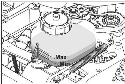
4. Dolać oleju silnikowego, jeśli poziom oleju znajduje się poniżej dolnej linii, lecz nie przelewać go powyżej górnej linii. Informację o zalecanym oleju zawiera *Dane techniczne na stronie 64*.
