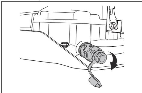
2. Aby bolo jednoduchšie vypustiť olej bez jeho úniku, nasadte na koniec vypúšťacieho uzáveru oleja napríklad plastovú hadicu.
