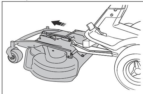
3. Zvedněte žací ústrojí do svislé polohy, dokud neuslyšíte cvaknutí. Žací ústrojí se automaticky zajistí ve svislé poloze.
