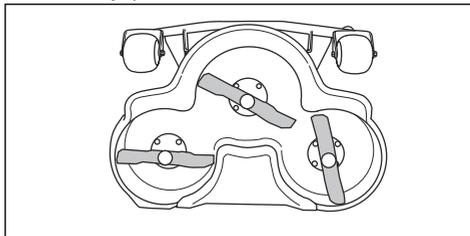
3. Skrutky nožov utiahnite na ťahovací moment 45–50 Nm.
