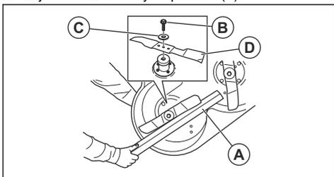
3. Uvolněte a demontujte šroub nože (B), podložky (C) a nůž (D).
