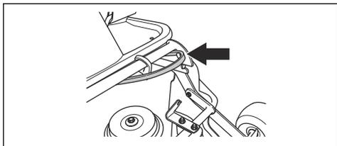
9. Vložte dřevěný špalík mezi rám ústrojí a podvozek. To zajistí, že při se demontáži nevrátí žací ústrojí zpět.
