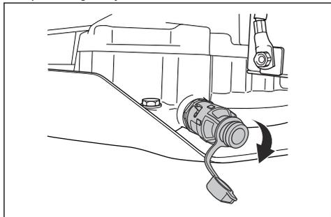
2. Aby ułatwić spuszczenie oleju silnikowego bez jego rozlania, przymocować na przykład plastikowy przewód na końcu korka spustowego oleju.
