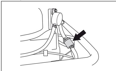
4. Wcisnąć nowy filtr paliwa w końcówki przewodów. Zastosować płynny detergent na końcówkach filtra paliwa, aby ułatwić połączenie.
