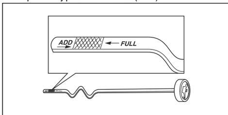
8. Doplňte olej otvorem, ve kterém je instalována olejová měрка. Olej doplňte pomalu.
