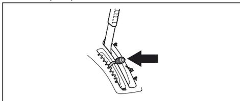
6. Stiskněte pojistné tlačítko na zvedací páce žacího ústrojí a spusťte jej do sekací polohy.
