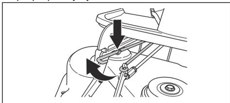
6. Vytažením oka pružiny povolte pružinu pro napnutí hnacího řemenu.
