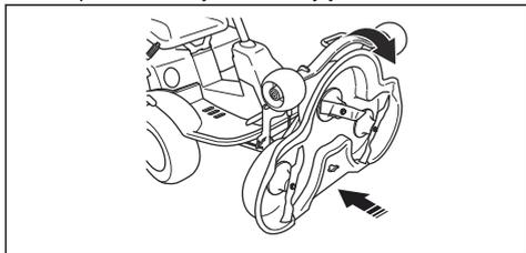
4. Zvedněte podpěru výšky sečení (A) z držáku podpěry a vložte ji do otvoru.
