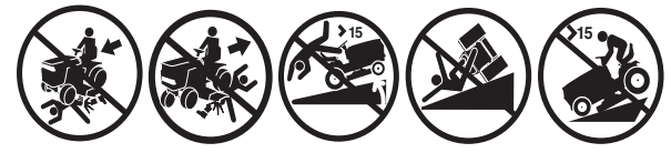
MANTENGA EL AREA DESPEJADA PELIGROS DE PENDIENTES (VEA LA SECCIÓN DE LAS REGLAS DE SEGURIDAD)
