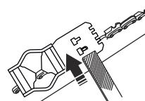
**Remarque :** La jauge de profondeur est bien réglée quand le passage de la lime sur l'outil de la jauge de profondeur ne produit aucune résistance.
