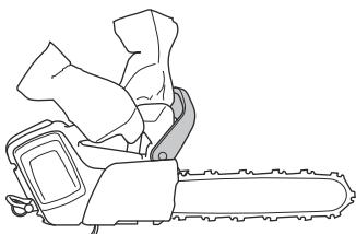
En position d'abattage, il n'est pas possible d'engager manuellement le frein de chaîne. Le frein de chaîne ne peut être engagé dans cette position qu'au moyen du mécanisme de déverrouillage de l'inertie.
