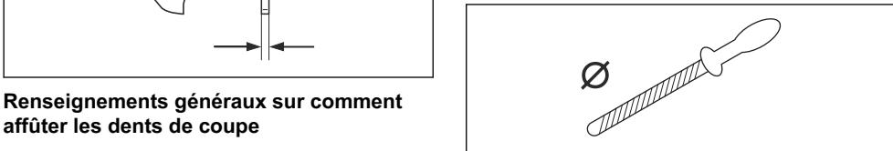
Il n'est pas facile d'affûter correctement une chaîne sans l'équipement adéquat. Il est recommandé d'utiliser le gabarit de lime Husqvarna. Cela permet de maintenir les performances de coupe au maximum et le risque de rebond au minimum.
