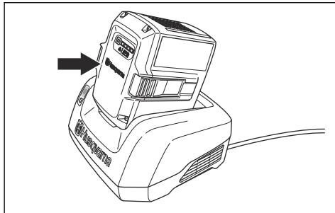
3. Vérifier que le témoin vert de mise en charge sur le chargeur s'allume. Cela signifie que la batterie est correctement branchée dans le chargeur.
