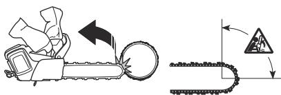
Le rebond se produit toujours dans le plan de coupe du guide-chaîne. Généralement, le produit, le guide-chaîne et la chaîne sont projetés contre l'utilisateur; ils peuvent aussi se déplacer dans un autre sens. C'est la façon dont le produit est utilisé lorsque le rebond se produit qui détermine le sens de déplacement.
