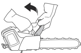
Un rebond peut être très soudain et violent. La plupart des rebonds sont faibles et n'engagent pas toujours le frein de chaîne. Si un rebond se produit lors de l'utilisation du produit, tenir fermement les poignées et ne pas les lâcher.
