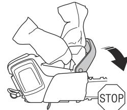
La manière dont le frein de chaîne est engagé dépend de la force du rebond. Elle dépend également de la position du produit lorsque la zone de rebond heurte un objet. En cas de rebond intense avec la zone de rebond le plus loin possible, le frein de chaîne s'engage par déverrouillage de la fonction d'inertie. Si le rebond est faible ou la zone de rebond est plus proche, le frein de chaîne s'engage manuellement par la main gauche.
