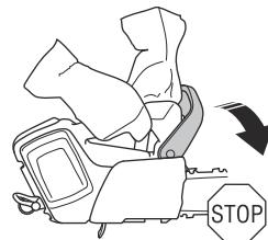
La forma de activación del freno de cadena depende de la fuerza de la reculada. También depende de la posición del producto cuando el sector de riesgo de reculada golpea un objeto. Si se produce una reculada intensa mientras usted está más alejado del sector de riesgo de reculada, el freno de cadena se activa por efecto de la inercia. Si la reculada es mínima o el sector
