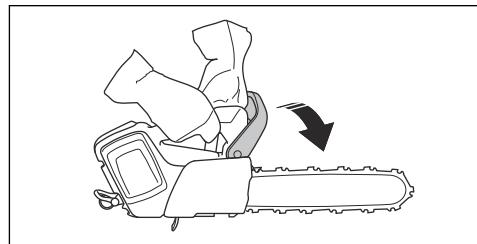
En la posición de tala, no se puede activar el freno de cadena manualmente. En esta posición, el freno de cadena solo se puede activar por el mecanismo de liberación por inercia.
