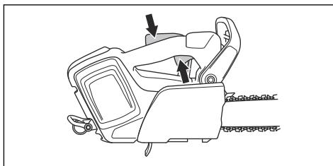
2. Appuyer sur le mécanisme de verrouillage de la gâchette et s'assurer qu'il retourne à sa position initiale lorsqu'on le relâche.
