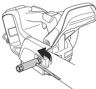
2. Levante la parte delantera de la espada guía y gire el tornillo de tensado de cadena. Utilice una llave.
