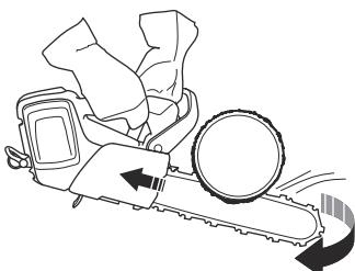
**AVERTISSEMENT :** Faire preuve de prudence lors d'une coupe poussante. Si la chaîne reste emprisonnée dans le tronc d'arbre, le produit peut être poussé dans votre direction. Éviter cette force où il y a un risque que la zone de rebond du guide-chaîne entre en contact avec l'arbre. Cela entraîne un rebond.
