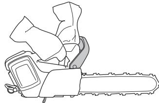
3. Aplique la máxima potencia e incline la muñeca izquierda hacia delante para acoplar el freno de cadena.
