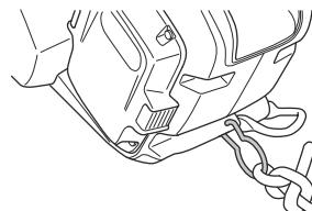
**Remarque :** Si l'opérateur perd le contrôle du produit, l'estrope permet d'éviter qu'il tombe au sol. Fixer l'œillet de la courroie sur le crochet du harnais de l'utilisateur en tant que principale procédure de sécurité. En cas d'utilisation de l'estrope en tant que principale procédure de sécurité, abaisser complètement le produit en bas de la corde de sécurité. Ne pas lâcher le produit en hauteur.
