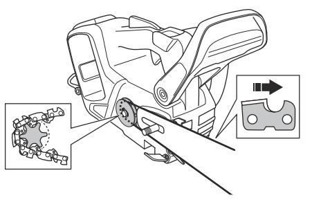
4. Asegúrese de que los rebordes de las uniones de corte estén orientados hacia delante en el reborde superior de la espada guía.
