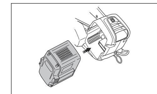
4. Appuyer sur la partie inférieure de la batterie jusqu'à entendre un clic sonore.
