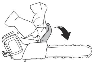
3. Coloque la batería en el soporte para batería.
