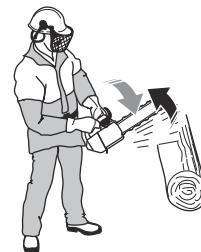
Utiliser le frein de chaîne en tant que frein de stationnement lors du démarrage du produit ou de déplacement sur de courtes distances. Cela réduit le
