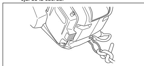
**Tenga en cuenta:** Si el operador pierde el control del producto, la correa evitará que el producto caiga al suelo. Fije el ojal de la correa en el gancho del arnés del operador como un procedimiento principal de seguridad. Si utiliza la correa como procedimiento principal de seguridad, baje el producto completamente a la cuerda de seguridad. No suelte el producto desde altura.
