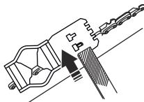
**Tenga en cuenta:** Para saber si el ajuste del calibre de profundidad es el correcto, no debe sentir una resistencia cuando pase la lima por el calibrador de profundidad.
