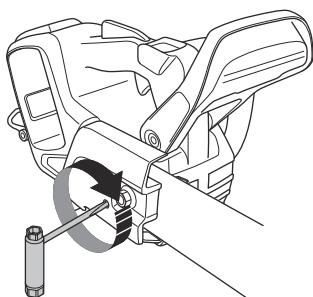
4. Serrer les écrous du guide-chaîne à l'aide de la clé et soulever l'avant du guide-chaîne en même temps.
