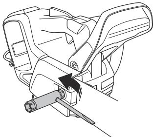
2. Soulever l'avant du guide-chaîne et tourner la vis de réglage de tension de la chaîne. Utiliser une clé.
