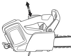
3. Asegúrese de que el gatillo de alimentación esté bloqueado en la posición de ralentí cuando se suelta el bloqueo del gatillo de alimentación.
