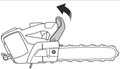
2. Retire la tuerca de la espada, la cubierta del piñón de arrastre y el anillo de transporte (A).
