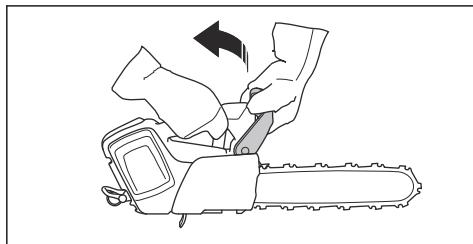
Una reculada puede ser repentina e intensa. La mayoría de las reculadas son mínimas y no siempre activan el freno de cadena. Si se produce una reculada cuando
