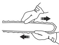
6. Vérifier la tension de la chaîne fréquemment jusqu'à ce que la chaîne soit rodée.
