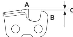
**ADVERTENCIA:** Si el ajuste del calibre de profundidad es demasiado, el riesgo de reculada aumenta.
