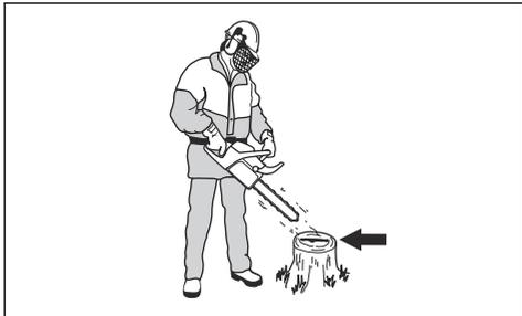
3. Si la lubrification de la chaîne ne fonctionne pas correctement, vérifier le guide-chaîne. Se reporter à la section *Pour vérifier le guide-chaîne à la page 35* pour obtenir des instructions. Communiquer avec le centre d'entretien si les mesures d'entretien ne suffisent pas.
