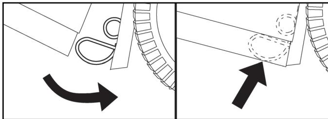
**POZNÁMKA:** Při nastavování výšky sestavy pytlovače může být nutné upravit pérovou západku pytlovače. Chcete-li provést úpravu, odstraňte matici (4) a přesuňte pérovou západku pytlovače do odpovídajícího otvoru zadní desky (1) a zajistěte, aby byla sestava pytlovače bezpečně uzavřená. Pevně utáhněte matici.
