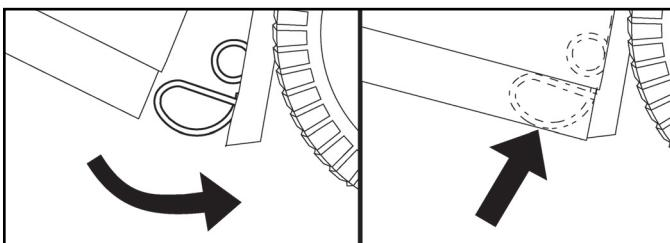
**POZNÁMKA:** nastavená výška zostavy vaku, možno bude treba upraviť pružinovú západku vaku. Pri nastavovaní vyberte maticu (4) a presuňte pružinovú západku vaku do príslušného otvoru v zadnej platni (1) a uistite sa, že zostava vaku sa pevne uzavrie. Maticu pevne dotiahnite.
