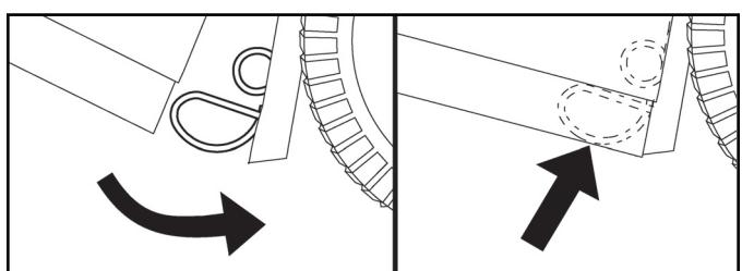
**NAPOMENA:** ako podešavate visinu sklopa košare, možda ćete morati podešiti i opružni zatvarač košare. Za podešavanje, izvadite maticu (4) i pomaknite opružni zatvarač košare u odgovarajuću rupicu na stražnjoj ploči (1) te osigurajte da će sklop košare biti čvrsto zatvoren. Ponovno čvrsto zategnjte maticu.
