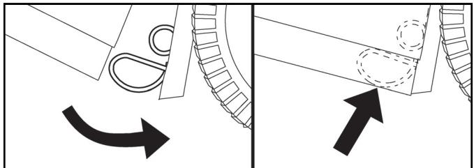
**UWAGA:** W przypadku regulacji wysokości zespołu kosza konieczna może być również regulacja zaczepu sprężynowego kosza. Aby dokonać regulacji, odkręcić nakrętkę (4) i przesunąć zaczep do odpowiedniego otworu w płycie tylnej (1), tak aby zapewnić odpowiednie zamknięcie kosza. Mocno dokręcić śrubę.
