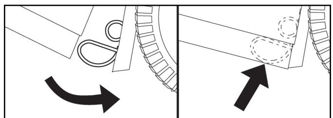
**MEGJEGYZÉS:** Ha a fügyűjtő szerelvény magasságának beállítása megtörtént, szükség lehet a fügyűjtő rugós reteszének beállítására. A beállításhoz távolítsa el az anyát (4), és helyezze át a fügyűjtő rugós reteszét a megfelelő furatba a hátlapon (1), gondoskodva arról, hogy a fügyűjtő szerelvény biztonságosan zárjon. Húzza meg újra szorosan az anyát.
