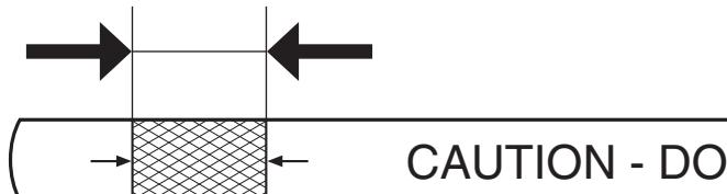
(CZ) Hladina by se měla nacházet mezi dvěma značkami na měrce. V případě potřeby dopřáte olej tak, aby hladina dosáhla na horní okraj mřížkován značky na měrce. Pro přibližný objem a typ oleje viz část „SPECIFIKACE PRODUKTU“ této příručky. Nepřeplňujte.
