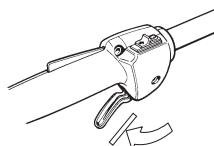
Wcisnij blokadę dźwigni gazu i sprawdź, czy po zwolnieniu nacisku powraca ona do położenia wyjściowego.
