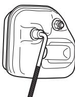
Jeśli tłumik w Twojej maszynie jest wyposażony w siatkę przeciwiskrową, należy ją regularnie czyścić. Zanieczyszczona siatka powoduje przegrzewanie się silnika, co może być przyczyną poważnych uszkodzeń.
