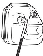
Ha az Ön gépén a kipufogódob szikrafogó hálóval rendelkezik, akkor azt rendszeresen tisztíteni kell. Eltömödött háló a motor túlmelegedését okozza, ami a motor komoly károsodásához vezethet.
