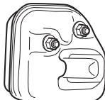
A száraz és meleg klímájú országokban nagyobb a tűzveszély. Ezért az ide szállított berendezéseket úgynevezett szikrafogóhálóval látjuk el. Ellenőrizze, hogy az Ön gépének hangfogóján van-e ilyen háló.
