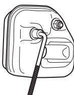
Ak je tlmič výfuku na vašom stroji vybavený zachytávačom iskier, je potrebné ho pravidelne čistiť. Zanesený zachytávač spôsobí prehriatie motora a môže zapríčiniť jeho vážne poškodenie.
