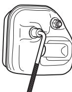
Pokud je tlumič výfuku na stroji vybaven lapačem jisker, musí se sítko lapače pravidelně čistit. Ucpané sítko lapače způsobuje přehřátí motoru a může vést k vážnému poškození stroje.
