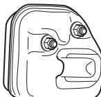
V zemích s teplým a suchým podnebím je nebezpečí vzniku požáru zvýšeno. Z toho důvodu opatřujeme některé tlumiče zvuku lapačem jisker v podobě síťky. Zkontrolujte, zdali je tlumič zvuku na vašem stroji vybaven takovou sítkou.
