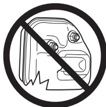
Kontrollér regelmæssigt, at lyddæmperen sidder fast i maskinen.
