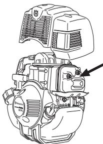
Din maskines lyddæmper er udstyret med et gnistfangernet, som skal rengøres regelmæssigt. Et tilstoppet net medfører, at motoren kører varm med alvorlig motorskade til følge.
