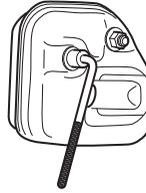
Jos koneesi äänenvaimennin on varustettu kipinänsammutusverkolla, on myös se puhdistettava säännöllisesti. Tukkeutunut verkko aiheuttaa moottorin kuumenemisen, mistä seuraa vakava moottorivaurio.
