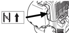
**Brændstofpumpe:** Tryk flere gange på brændstofpumpens gummiblære, indtil blæren fyldes med brændstof. Det er ikke nødvendigt at fylde blæren helt.
