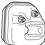
I land med varmt og tørt klima er skogbrannfare stor. Vi har derfor utstyrt noen av lyddempermodellene med et såkalt gnistfangernett. Kontroller om lyddemperen på din maskin har et slikt nett.
