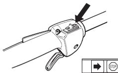
Start motoren, og kontrollér, at motoren slukkes, når stopkontakten sættes i stopposition.
