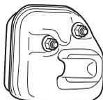
I länder med varmt och torrt klimat är risken för bränder påtaglig. Vi har därför utrustat vissa ljuddämpare med ett sk. gnistfångarnät. Kontrollera om din maskins ljuddämpare har ett sådant nät.
