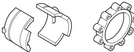
Kontrollera regelbundet avvibreringselementen efter materialsprickor och deformationer. Kontrollera att avvibreringselementen är hela och fast förankrade.
