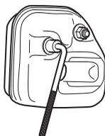
Er din maskines lyddæmper udstyret med et gnistfangernet, skal dette renses regelmæssigt. Et tilstoppet net medfører, at motoren kører varm med alvorlig motorskade til følge.
