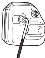
Är din maskins ljuddämpare utrustad med ett gnistfångarnät, skall detta rengöras regelbundet. Ett igensatt nät leder till varmkörning av motorn med allvarig motorskada som följd.
