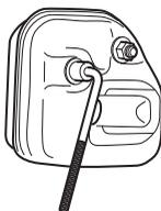
Hvis lyddemperen i maskinen er utstyrt med gnistfangernett, må dette rengjøres regelmessig. Et tilstoppet nett fører til at motoren går varm med alvorlig motorskade som følge.
