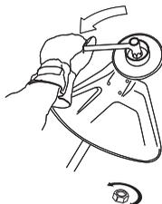
Låsemøtrikkens nylonlås må ikke være så slidt, at den kan drejes med fingrene. Låsen skal holde mindst 1,5 Nm. Møtrikken skal udskiftes, når den har været skruet på ca. 10 gange.
