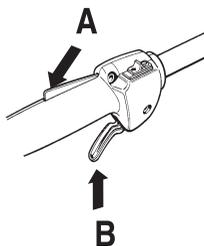
Kontroller at gassregulatoren er låst i tomgangsstilling når gassregulatorsperren er i sin utgangsposisjon.
