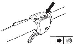
Starta motorn och kontrollera att motorn stängs av när stoppkontakten förs till stoppläget.
