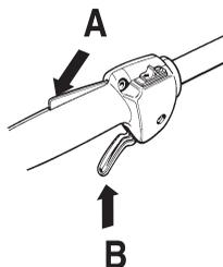
Kontrollér, at gasreguleringen er låst i tomgangsstilling, når gasreguleringslåsen befinder sig i udgangsstilling.
