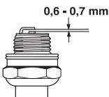
**BEMÆRK!** Brug altid anbefalet tændrørstype! Forkert tændrør kan ødelægge stempel/cylinder. Kontrollér, at tændrøret har såkaldt radiostøjdæmpning.
