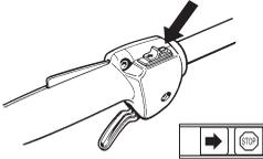
Käynnistä moottori ja tarkasta, että moottori pysähtyy, kun pysäytin siirretään pysäytysasentoon.
