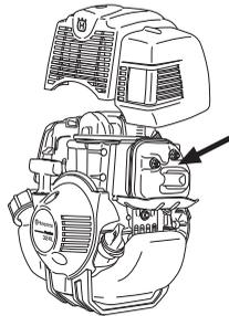
Koneesi äänenvaimennin on varustettu kipinänsammutusverkolla, joka on puhdistettava säännöllisesti. Tukkeutunut verkko aiheuttaa moottorin kuumenemisen, mistä seuraa vakava moottorivaurio.
