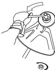
Låsmutterns nylonlåsning får ej vara så sliten att den kan skruvas med fingrarna. Låsningen ska hålla minst 1,5 Nm. Muttern ska bytas efter det att den skruvats på ca 10 gånger.
