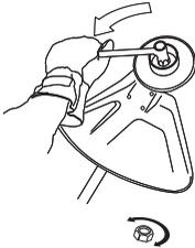
Lukitusmutterin nailonlukitus ei saa olla niin kulunut, että sitä voi ruuvata käsin. Lukituksen on kestettävä vähintään 1,5 Nm. Mutteri on vaihdettava, kun se on ruuvattu kiinni noin 10 kertaa.
