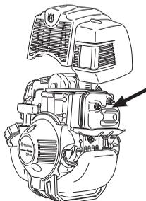
Din maskins lyddemper er utstyrt med et gnistfangernett, dette skal rengjøres regelmessig. Et tilstoppet nett fører til at motoren går varm med alvorlig motorskade som følge.
