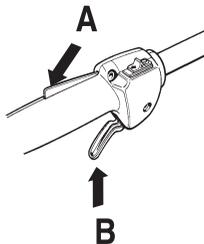
Kontrollera att gasreglaget är låst i tomgångsläge när gasreglagespärren är i sitt ursprungsläge.
