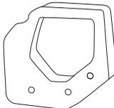
Pitkään käytössä ollut ilmansuodatinta ei saa koskaan täysin puhtaaksi. Siksi ilmansuodatin on vaihdettava säännöllisin väliajoin. **Vaurioitunut ilmansuodatin on aina vaihdettava.**
