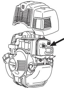
Din maskins ljuddämpare är utrustad med ett gnistfångarnät, detta skall rengöras regelbundet. Ett igensatt nät leder till varmkörning av motorn med allvarlig motorskada som följd.
