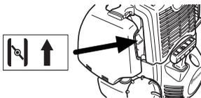
**Bränslepump:** Tryck på bränslepumpens gummiblåsa upprepade gånger tills bränsle börjar fylla blåsan. Blåsan behöver ej fyllas helt.
