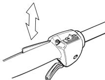
Kontrollera att gasreglaget och gasreglagespärren går lätt samt att deras retur fjäder system fungerar.
