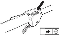
Start motoren og kontroller at motoren blir slått av når stoppbryteren føres til stopstilling.
