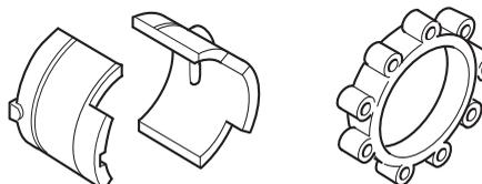
Kontrollér regelmæssigt vibrationsdæmpningselementerne for materialerevner og deformationer. Kontrollér, at vibrationsdæmpningskomponenterne er intakte og fast forankrede.
