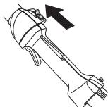
**REMARQUE!** L'interrupteur d'arrêt se remet automatiquement en position de démarrage. Toujours retirer le chapeau de bougie de la bougie lors du montage, contrôle et/ou entretien, afin d'éviter tout démarrage accidentel.
