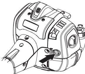
**Estrangulador:** Suba el estrangulador hasta la posición de estrangulamiento.
