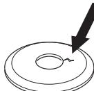
S'assurer que le contre-écrou n'a pas perdu son pouvoir bloquant. Le contre écrou doit résister à au moins 1,5 Nm. Le couple de serrage du contre-écrou doit être de 35-50 Nm.
