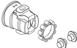
Compruebe regularmente que los elementos antivibraciones no estén agrietados o deformados. Controle que los amortiguadores de vibraciones estén enteros y bien sujetos.
