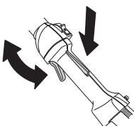
Voir le chapitre Démarrage. Démarrer la machine et donner les pleins gaz. Relâcher l'accélérateur et s'assurer que l'équipement de coupe s'arrête et qu'il reste immobile. Si l'équipement de coupe tourne lorsque l'accélérateur est au régime de ralenti, contrôler le réglage du ralenti du carburateur. Voir le chapitre Entretien.
