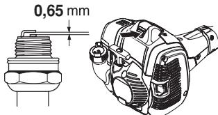
**¡NOTA!** ¡Utilice siempre el tipo de bujía recomendado! Una bujía incorrecta puede arruinar el pistón y el cilindro. Asegúrese de que la bujía tenga supresión de perturbaciones radioeléctricas.
