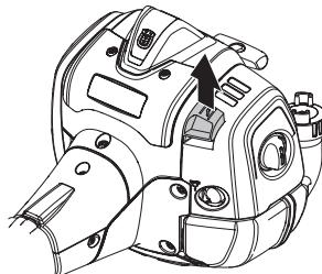
Desmonte la cubierta del filtro de aire y retire el filtro. Lávolo en agua jabonosa caliente. Limpie también el interior de la cubierta del filtro con aire o un cepillo. Controle que el filtro esté seco antes de volver a montarlo.
