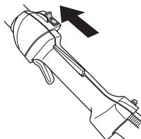
Mettre le moteur en marche et s'assurer qu'il s'arrête lorsque le bouton d'arrêt est amené en position d'arrêt.
