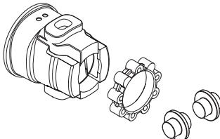
Vérifier régulièrement l'état des éléments afin de détecter fissures et déformations. Vérifier que les éléments anti-vibrations sont entiers et solidement fixés.
