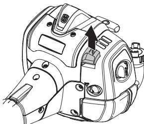
Déposer le capot de filtre et retirer le filtre. Nettoyer le filtre avec de l'eau chaude savonneuse. Nettoyez aussi l'intérieur du couvercle du filtre avec de l'air ou une brosse. S'assurer que le filtre est sec avant de le remonter.
