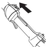
**¡NOTA!** El contacto de parada retorna automáticamente a la posición de arranque. Por consiguiente, antes de realizar trabajos de montaje, control y/o mantenimiento se debe quitar el capuchón de encendido de la bujía para evitar el arranque imprevisto.
