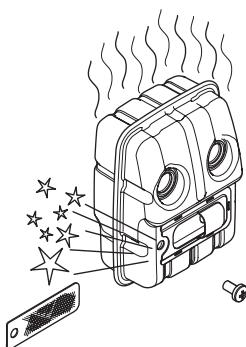
**REMARQUE!** Ne jamais utiliser la machine si le silencieux est en mauvais état.
