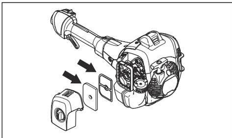
3. Zračne filtre očistite s toplo milnico.
