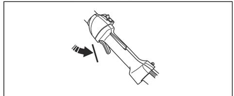
3. Drücken Sie die Gashebelsperre herunter, und kontrollieren Sie, ob sie beim Loslassen in die Ausgangsstellung zurückkehrt.
