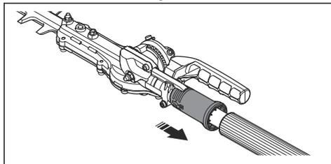
3. Schwenken Sie die Schneideinheit in die korrekte Position. Verwenden Sie eines der folgenden Verfahren.
