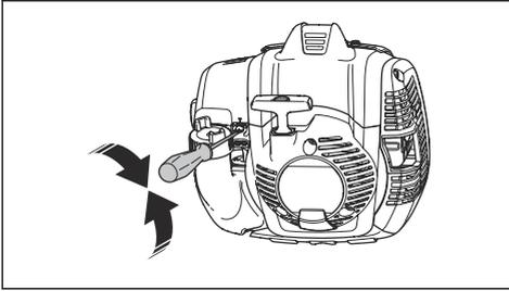
4. Drehen Sie die Stellschraube gegen den Uhrzeigersinn, bis die Schneideinheit stehen bleibt.
