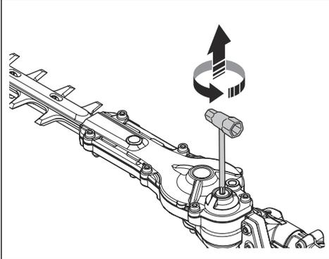
2. Führen Sie den Kombischlüssel in das Getriebe ein und drehen Sie ihn im und gegen den Uhrzeigersinn. Stellen Sie sicher, dass sich die Klingen frei bewegen können.
