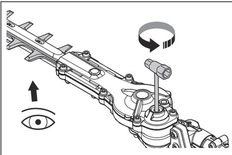
3. Überprüfen Sie die Kanten der Klingen auf Schäden oder Verformungen.
