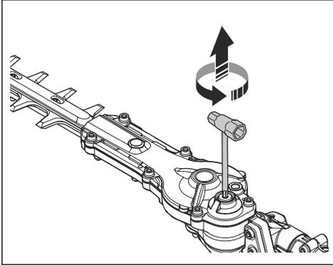
2. Kombiniran ključ vstavite v menjalnik ter ga obrnite v smeri urinega kazalca in v nasprotni smeri urinega kazalca. Prepričajte se, da se rezila nemoteno vrtijo.
