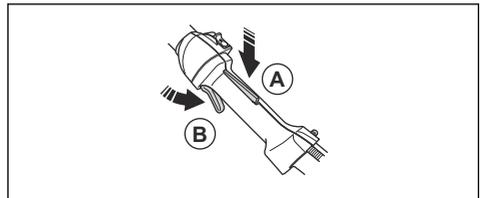
2. Stellen Sie sicher, dass der Gashebel in der Leerlaufstellung verriegelt ist, wenn die Gashebelsperre freigegeben wird.
