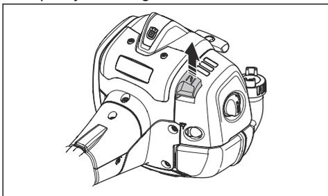
2. Odstranite pokrov zračnega filtra in zračne filtre.
