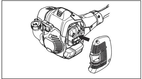
3. Entfernen Sie die Schraube zur Befestigung des Funkenfängernetzes.
