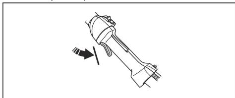
3. Potisnite zaklep ročice plina navzdol in se prepričajte, da se vrne v začetni položaj, ko ga sprostite.
