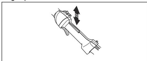
4. Zaženite izdelek in pritisnite polni plin. Glejte razdelek *Zagon motorja na strani 36*.
