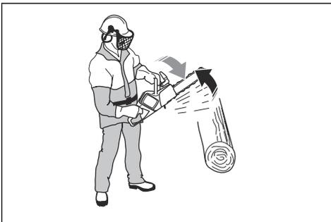
Verwenden Sie die Kettenbremse als Feststellbremse, wenn Sie das Gerät starten und sich über kurze
