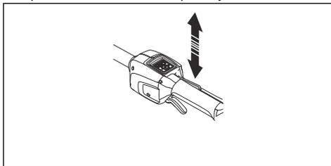
3. Prepričajte se, da se sprožilec plina in zapora prosto premakata in da povratna vzmet pravilno deluje.
