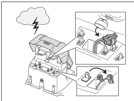
Um das Risiko der Beschädigung von Komponenten im Gerät und der Ladestation zu verringern, empfehlen wir, bei Gewittergefahr alle Verbindungen zur Ladestation (Netzteil, Begrenzungskabel und Leitkabel) zu trennen.
