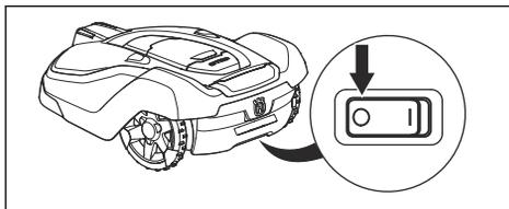
3. Drehen Sie das Gerät um. Legen Sie das Gerät auf eine weiche, saubere Oberfläche, um Beschädigungen des Gehäuses und der Abdeckung zu vermeiden.
