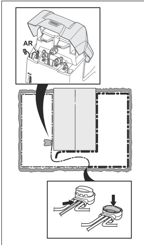
Leuchtet die Anzeigelampe jetzt grün, befindet sich der Bruch an einer Stelle zwischen dem ausgesteckten Ende und der Stelle, an der das neue Kabel angeschlossen wurde (dicke schwarze Linie unten). In diesem Fall verschieben Sie das neue Kabel näher in Richtung ausgestecktes Ende (ungefähr in der Mitte des Bereichs, in dem der Bruch vermutet
