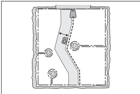
Die Korridorbreite wird automatisch eingestellt. Nur in seltenen Fällen müssen die Einstellungen manuell eingegeben werden. Die Korridorbreite kann zwischen 0-9 eingestellt werden. Wenn die Korridorbreite des Leitkabels auf 0 eingestellt ist, überfährt das Gerät das Leitkabel. Die Werkseinstellung ist 6 für das Begrenzungskabel und 9 für das Leitkabel.
