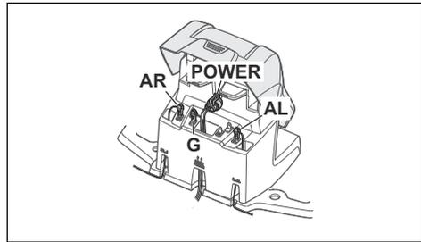
3. Wechseln Sie zwischen den Anschlüssen von Leitkabel und Begrenzungskabel mit der Ladestation.
