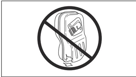
**Povšimněte si:** Vnitřní povrchy tlumiče výfuku obsahují chemikálie, které způsobují rakovinu. Nedotýkejte se těchto prvků, pokud je tlumič poškozený.
