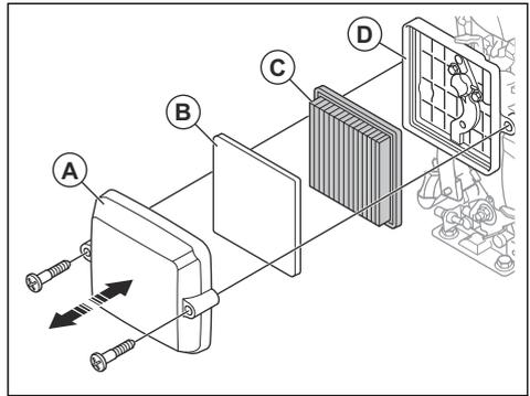
2. Entfernen Sie das Schaumfilterelement (B) vom Luftfilterdeckel.
