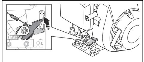
2. Stellen Sie den Motor-Ein-/Ausschalter auf „OFF“ (Aus). Der Motor wird angehalten.
