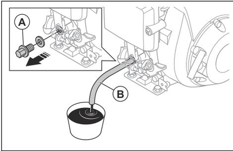
3. Neigen Sie das Gerät und lassen Sie das Öl in den Behälter laufen.
