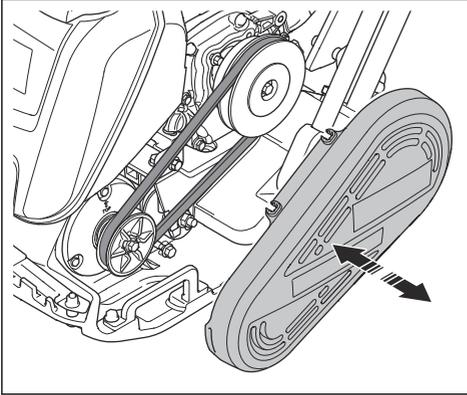
3. Überprüfen Sie den Keilriemen auf Beschädigung und Verschleiß. Ersetzen Sie den Keilriemen bei Bedarf.
