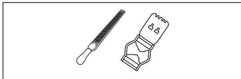
1. Pour le réglage de la jauge de profondeur, utilisez une lime plate et un gabarit d'affûtage. Utilisez uniquement le gabarit d'affûtage Husqvarna pour obtenir l'épaisseur souhaitée et le bon angle pour la jauge de profondeur.
