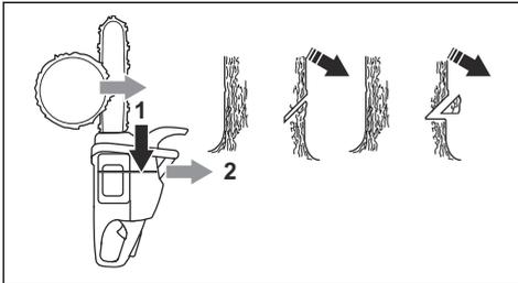
2. Assurez-vous que l'entaille inférieure est horizontale et à un angle de  $90^{\circ}$  par rapport au sens de la chute.
