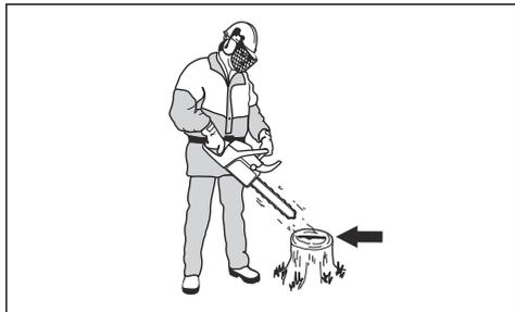
3. Si la lubrification de la chaîne ne fonctionne pas correctement, vérifier le guide-chaîne. Se reporter à la section *Pour vérifier le guide-chaîne à la page 34* pour obtenir des instructions. Communiquer avec le centre d'entretien si les mesures d'entretien ne suffisent pas.
