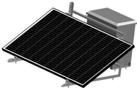
Assim que o painel estiver fixo, ligue o painel solar através dos conetores MC-4 ligados aos conetores MC-4 que saem do armário (macho > fêmea, fêmea > macho).
