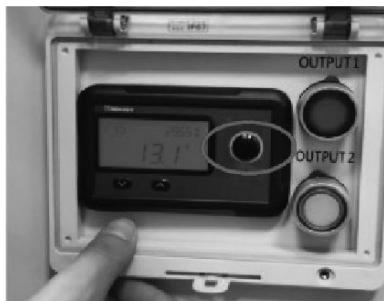
De to udgangsknapper ved siden af monitoren er til at tænde og slukke for ladestationens udgange.
