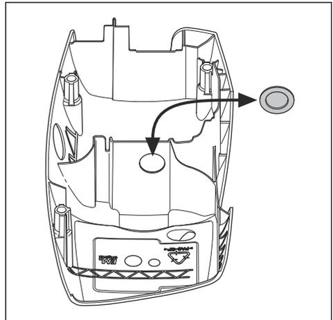
2. Si la température est inférieure ou égale à  $-5^{\circ}\text{C}$  ( $23^{\circ}\text{F}$ ), montez le capot d'hiver sur le corps du lanceur.
