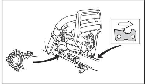
6. Alignez l'orifice avec le guide-chaîne grâce à la goupille de réglage de la chaîne, puis installez le carter d'embrayage.
