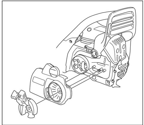
**Remarque:** si le carter d'embrayage est difficile à retirer, serrez l'écrou du guide-chaîne, serrez le
