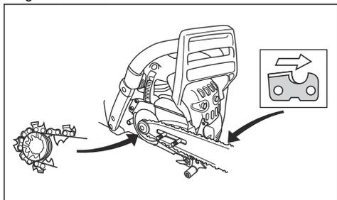
6. Alignez l'orifice avec le guide-chaîne grâce à la goupille de réglage de la chaîne, puis installez le carter d'embrayage.
