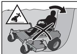
**AVERTISSEMENT!** Ne jamais conduire en montée ou en descente dans les pentes dont l'inclinaison est supérieure à 10°. Ne jamais conduire en travers de la pente.
