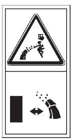
Nigdy nie kierować otworu wylotowego na osoby postronne, zwierzęta lub okna.
