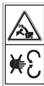
Wyłączać silnik przed rozpoczęciem czyszczenia obudowy ślimaka lub otworu wylotowego. Nigdy nie wkładać stóp ani dłoń do ślimaka ani do otworu wylotowego podczas pracy odśnieżacza.
