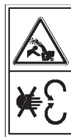
Coupez le moteur avant de nettoyer le logement de vis sans fin ou la goulotte de sortie. Ne mettez jamais votre pied ou votre main dans la vis sans fin ou dans la goulotte de sortie lorsque la fraise à neige est en train de fonctionner.
