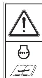
Coupez le moteur avant d'effectuer une opération de maintenance ou de réparation.
