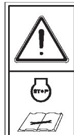
Spegnere il motore prima di eseguire operazioni di manutenzione o riparazione.
