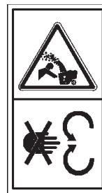
Sluk for motoren, før du renser
