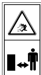
Se till, att ingen befinner sig i snöslungans körriktning och att ingen kommer närmare än fem meter under arbetets gång.
