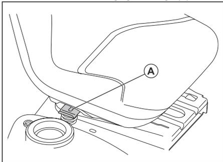
3. Déplacer le siège jusqu'à ce qu'il soit dans une position où l'on peut appuyer sur les pédales de frein et d'embrayage.
