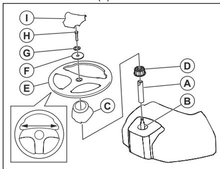
2. Installer le couvercle d'arbre (C). S'assurer que les pattes de guidage du couvercle d'arbre sont aux bonnes positions.
