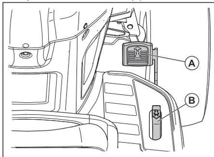
**Remarque :** Les pédales de commande de déplacement en marche avant et arrière reviennent en position neutre lorsqu'elles ne sont pas poussées vers le bas.
