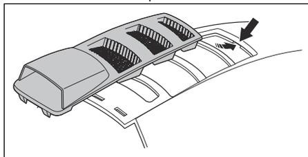
2. Aligner les pattes arrière de la pièce du couvercle du moteur avec les découpes dans ce couvercle.
