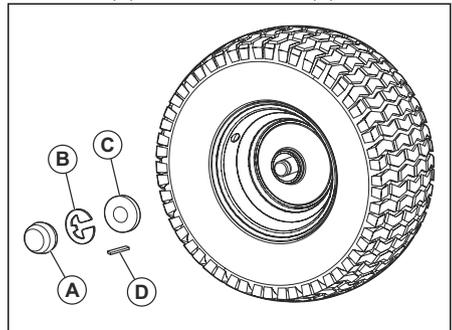
**Remarque :** Il y a des clavettes carrées uniquement sur les roues arrière.
