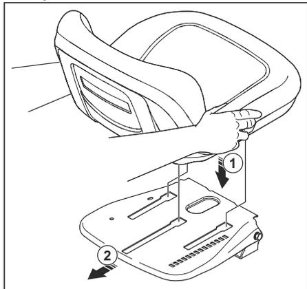
6. Rabattre le siège vers l'avant et installer les deux boulons (F) et les deux rondelles (G).
