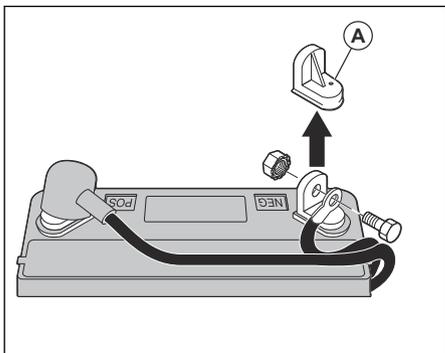
4. Brancher le câble de batterie rouge sur la borne positive (+) et serrer le boulon et son écrou comme illustré. Placer le cache sur la borne.
