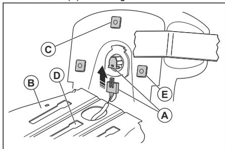
4. Placer le siège sur le plateau du siège (B) et placer la pièce en plastique centrale (C) dans le trou d'assemblage de la fente centrale (D).
