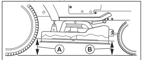
**Remarque :** Pour obtenir la meilleure coupe possible, les lames doivent être ajustées de manière à ce que l'avant soit d'environ 3,1 à 12,7 mm (1/8 à 1/2 po) plus bas que l'arrière lorsque l'unité de coupe est à la position la plus élevée.
