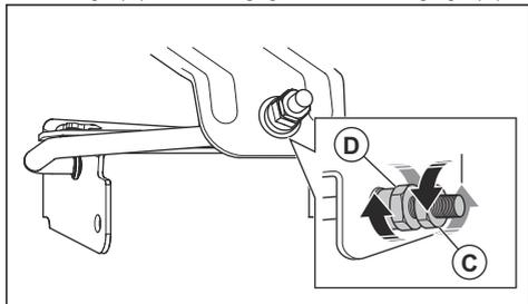
8. Régler la hauteur de coupe à l'aide d'une clé de 3/4 po.
