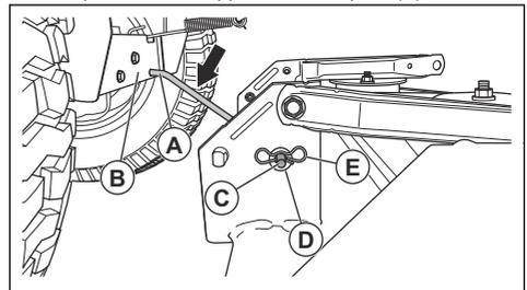
2. Placer l'extrémité de la rondelle intégrée (C) de la barre stabilisatrice dans le trou du support arrière sur le côté droit de l'unité de coupe. Déplacer l'unité de coupe, au besoin.
