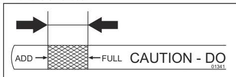
5. Insérer la jauge dans le tube de remplissage d'huile. S'assurer que le bouchon de remplissage d'huile est bien serré.
