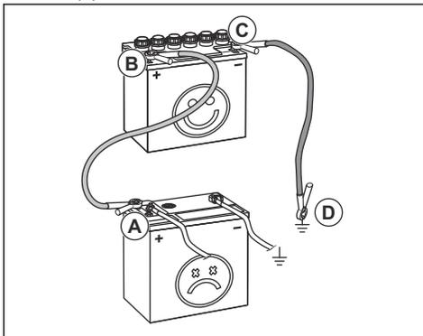
2. Raccorder l'autre extrémité du câble rouge à la borne POSITIVE (+) de la batterie chargée (B).
