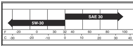
**Remarque :** Les huiles multiviscosité (5W30, 10W30 et ainsi de suite) aident le moteur à démarrer plus facilement par temps froid, mais provoquent une plus grande consommation d'huile lorsqu'elles sont utilisées à des températures au-dessus de 0 °C (32 °C). Vérifiez plus souvent le niveau d'huile du moteur pour éviter tout risque de dommage au moteur dû à un faible niveau d'huile.
