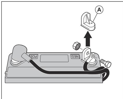
4. Brancher le câble de batterie rouge sur la borne positive (+) et serrer le boulon et son écrou comme illustré. Placer le cache sur la borne.
