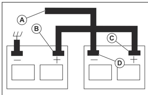
1. Raccorder une extrémité du câble ROUGE à la borne POSITIVE (+) de chaque batterie (B-C).
