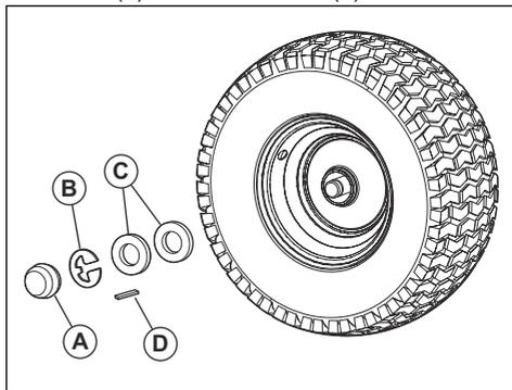
**Remarque :** Il y a des clavettes carrées uniquement sur les roues arrière.
