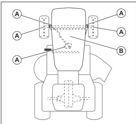
A. Graissage général. Graisser le raccord de graissage de broches, le roulement de roue avant et les dents d'engrenage du système de direction.
