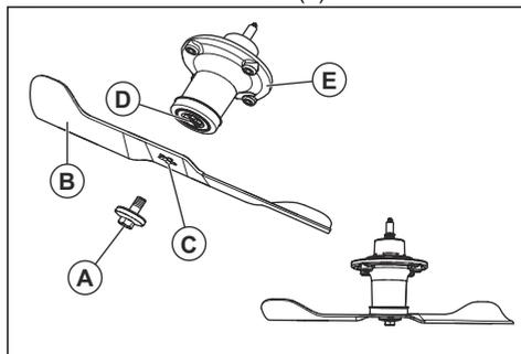
3. Installer la nouvelle lame ou la lame affûtée et le boulon.
