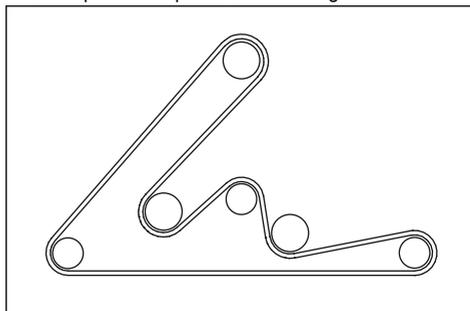
3. Installer la courroie en commençant par la partie arrière de la poulie du mandrin gauche.
