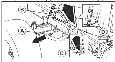
3. Soulever avec précaution le couvercle inférieur (B) pour libérer les languettes (C) du couvercle pour les fentes qui rétrécissent (D).
