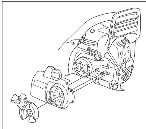
**Remarque:** si le carter d'embrayage est difficile à retirer, serrez l'écrou du guide-chaîne, serrez le frein de chaîne, puis desserrez-le. Vous entendez un clic lorsqu'il est desserré correctement.
