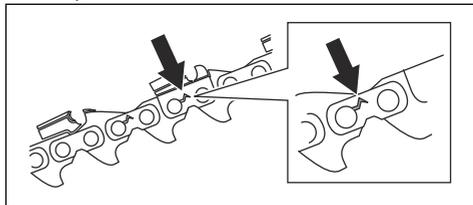
2. Vérifiez que la chaîne peut être courbée facilement. Remplacez la chaîne si elle est rigide.
