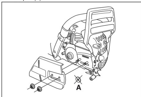
**Remarque:** Si le carter d'embrayage est difficile à retirer, serrez l'écrou du guide-chaîne, serrez le frein de chaîne, puis desserrez-le. Vous entendez un clic lorsqu'il est desserré correctement.
