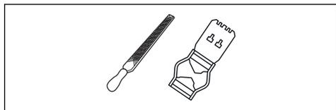
1. Pour ajuster le réglage de la jauge de profondeur, utilisez une lime plate et un outil de jauge de profondeur. Utilisez uniquement un outil de jauge de profondeur recommandé Husqvarna pour obtenir le bon réglage et le bon angle pour la jauge de profondeur.
