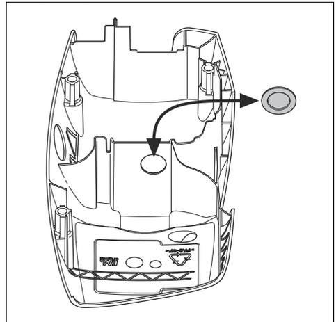
2. Si la température est inférieure ou égale à -5 °C/23 °F, montez le capot d'hiver sur le carter du lanceur.
