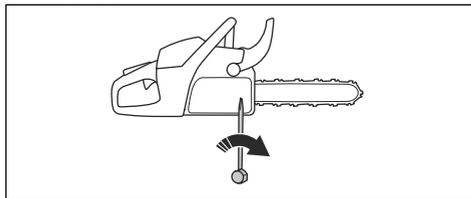
5. Serrez les écrous du guide-chaîne à l'aide de la clé et soulevez en même temps l'extrémité avant du guide-chaîne.
