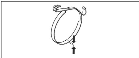
2. Contrôlez la bande de frein. La bande de frein doit mesurer 0,6 mm/0,024 po d'épaisseur minimum à son point le plus usé.
