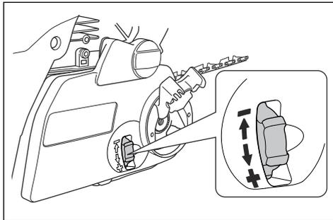
4. Tournez le bouton dans le sens des aiguilles d'une montre pour serrer le carter de l'embrayage.
