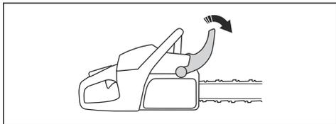
2. Tirez la commande du starter (A) vers l'extérieur pour la mettre en position de starter.
