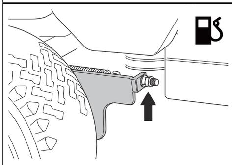
3. Juster jordtrykket på nytt når du bruker produktet med et klippeaggregat.
