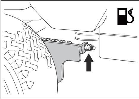
3. Vuelva a ajustar la presión sobre el suelo cuando utilice el producto con un equipo de corte.
