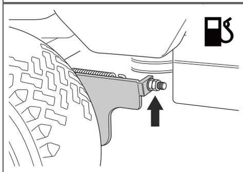
3. При последующем использовании изделия с режущей декой заново отрегулируйте давление на грунт.
