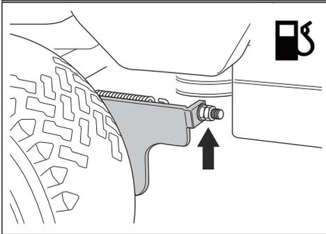
3. Повторно налаштуйте тиск на ґрунт для використання виробу з різальною декою.
