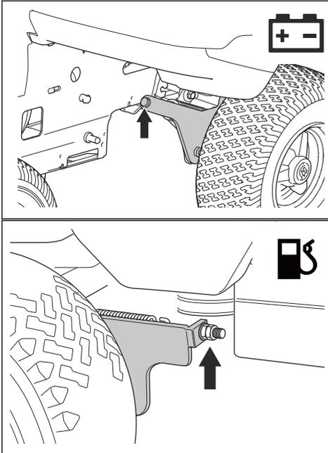
3. Ρυθμίστε ξανά την πίεση εδάφους όταν χρησιμοποιείτε το προϊόν με το πλαίσιο κοπής.
