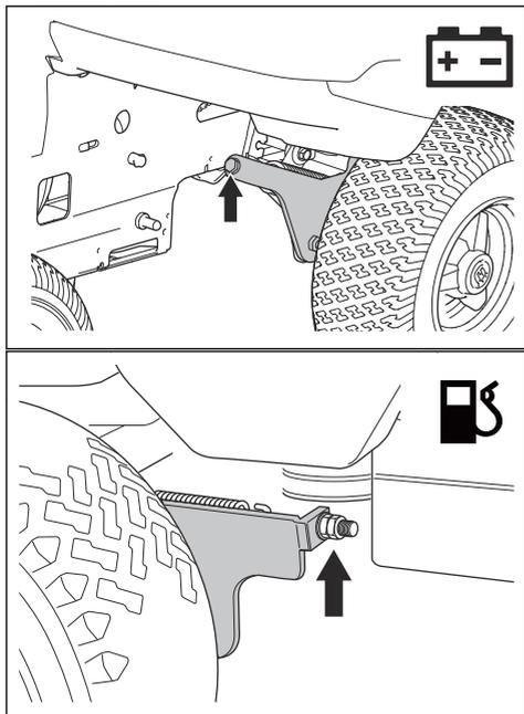
3. Ajuste novamente a pressão sobre o solo quando utilizar o produto com uma plataforma de corte.
