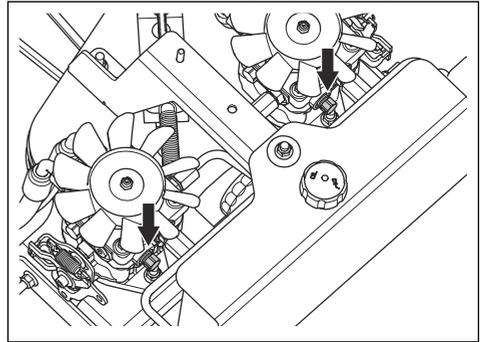
2. Tournez les boulons des soupapes de dérivation d'un maximum de 2 tours dans le sens antihoraire pour désengager le système d'entraînement. Utilisez une clé de 5/8 po.
