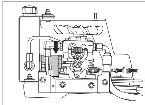
8. Lubrifiez légèrement le joint en caoutchouc du filtre à huile neuf avec de l'huile.
