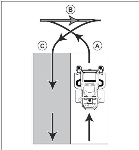
3. Tirer les deux leviers de commande pour les placer à la position de marche arrière et déplacer le produit vers l'arrière (B).
