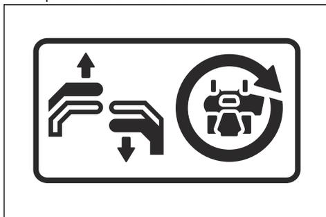
5. Tirer délicatement les deux leviers de commande vers l'arrière. Le produit va commencer à se déplacer vers l'arrière. La vitesse de marche arrière augmente à mesure que les deux leviers de commande sont tirés vers l'arrière.
