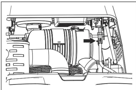
2. Régler le coupleur jusqu'à ce que la vitesse soit correcte. Lorsque l'unité est droite sur sa trajectoire et à la vitesse maximale correcte en marche avant, placer l'agrafe de retenue dans la tige de commande verticale pour verrouiller le coupleur.
