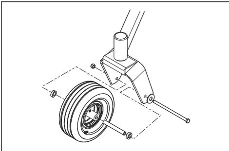
2. Effectuer l'installation dans l'ordre inverse. Serrer le boulon et l'écrou au couple de 67,8 N•m (50 lb-pi).
