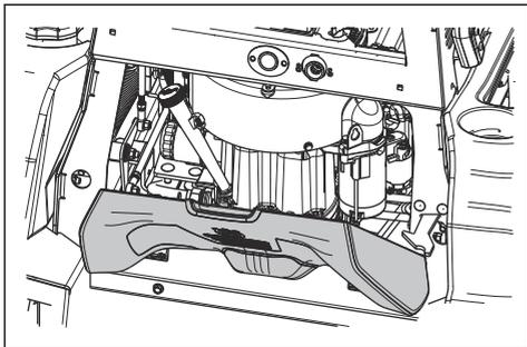
3. Incliner légèrement le couvercle du moteur vers le haut et soulever le bord arrière pour retirer le couvercle du moteur.
