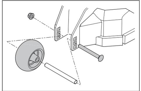
3. Installer le rouleau anti-arrachement dans l'une des trois positions.
