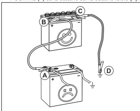
2. Raccorder l'autre extrémité du câble rouge à la borne POSITIVE (+) de la batterie sur la batterie complètement chargée (B).
