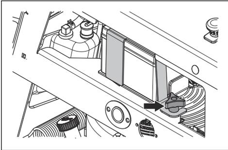
3. Utiliser deux clés pour débrancher le câble noir de la borne négative (-) de la batterie.
