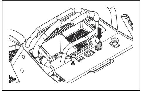
**Remarque :** Ne pas garder la clé de contact en position de démarrage pendant plus de 5 secondes à la fois. Si le moteur ne démarre pas, attendre 15 secondes avant de réessayer.
