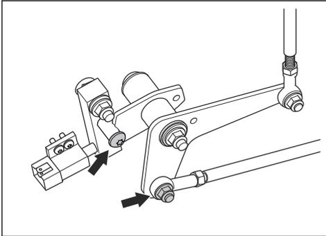
4. Faites tourner le renvoi d'angle jusqu'à ce que le rouleau se trouve dans la rainure.
