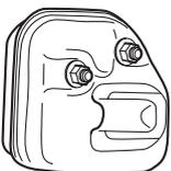
Le risque d'incendie est important dans les pays au climat chaud et sec. C'est pourquoi nous avons équipé certains silencieux de grilles antiflamme. Vérifier si le silencieux de la machine est muni d'un tel dispositif.
