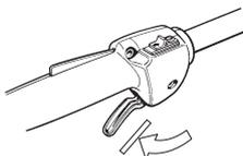
Appuyer sur le blocage de l'accélération et vérifier qu'il revient de lui-même en position initiale quand il est relâché.
