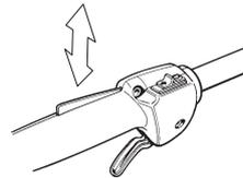
Vérifier que le blocage de l'accélération, la commande d'accélération et leurs ressorts de rappel fonctionnent correctement.
