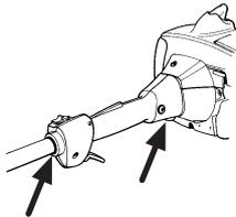
Le système anti-vibrations réduit la transmission des vibrations de l'unité moteur/l'équipement de coupe à l'unité que constituent les poignées.
