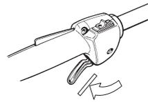
Appuyer sur le blocage de l'accélération et vérifier qu'il revient de lui-même en position initiale quand il est relâché.
