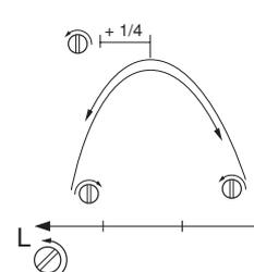
**REMARQUE!** Si les lames tournent au ralenti, tourner le pointeau de ralenti T dans le sens contraire des aiguilles d'une montre jusqu'à l'arrêt des lames.
