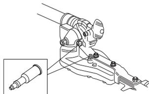
**REMARQUE!** L'engrenage ne doit pas être entièrement rempli de lubrifiant. Le lubrifiant se dilate sous l'effet de la chaleur qui se dégage lors du fonctionnement de la machine. Si l'engrenage est entièrement rempli de lubrifiant, les joints d'étanchéité risquent d'être endommagés, entraînant des fuites de lubrifiant.
