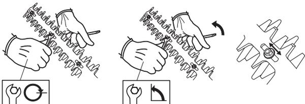
Lorsque les lames sont réglées correctement, un jeu de 0,2-0,4 mm entre les lames doit pouvoir être mesuré au niveau des vis.
