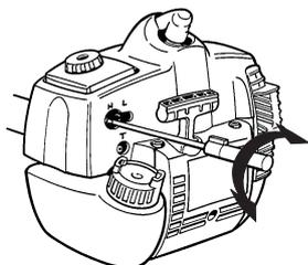
Donner les pleins gaz et tourner le pointeau haut-régime H très lentement dans le sens des aiguilles d'une montre jusqu'au ralentissement du moteur. Tourner ensuite le pointeau haut-régime H très lentement dans le sens inverse jusqu'à ce que le moteur tourne de manière irrégulière. Tourner ensuite légèrement le pointeau haut-régime H dans le sens des aiguilles d'une montre jusqu'à ce que le moteur tourne de manière régulière.
