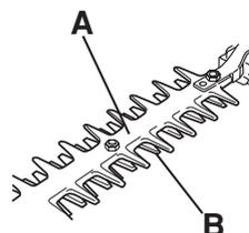
Contrôler le protège-couteau afin de détecter d'éventuels dommages ou déformations. Remplacer le protège-couteau s'il est courbé ou endommagé.
